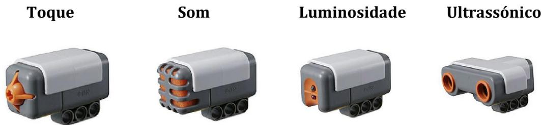
Figura 5: Ilustração dos sensores usados no kit Lego Mindstorms NXT
