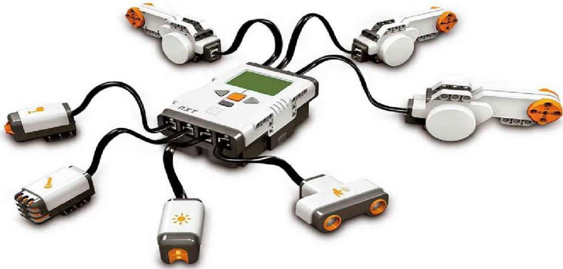
Figura 4 - Ilustração do bloco programável Lego NXT e das suas interfaces de ligação
