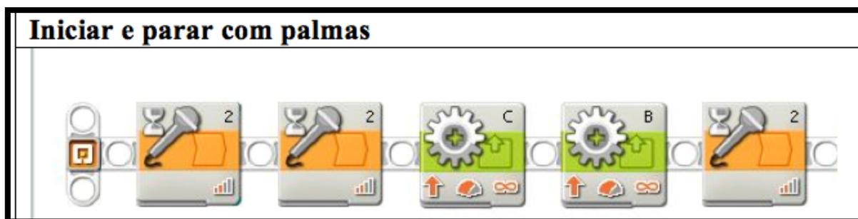
Figura 26 - Ilustração de um programa usando o sensor de som
