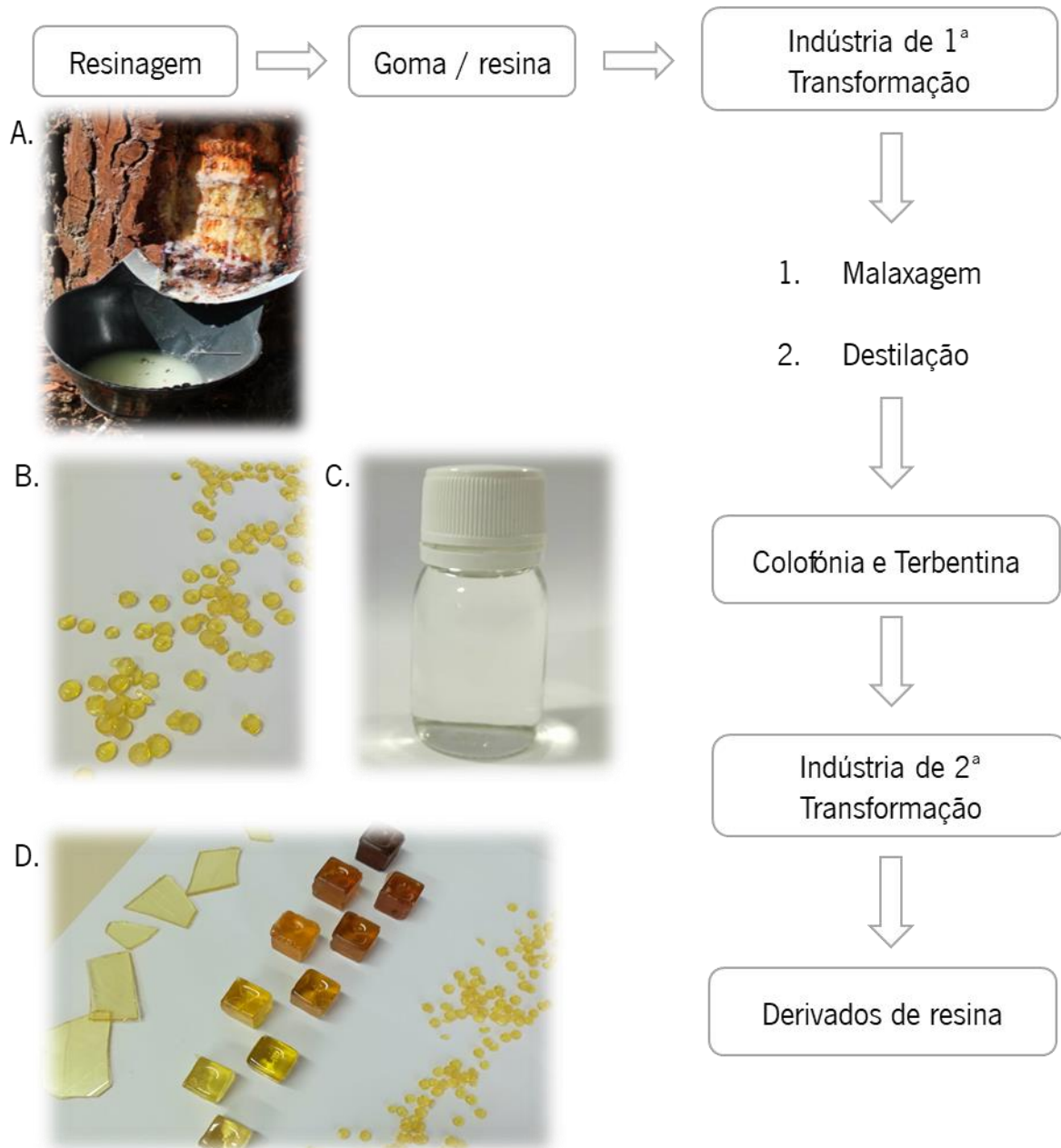
Figura 2.2 - Fases de processamento da resina: A – Resinagem; B – Colofónia; C – Terebentina; D - Derivados de resina. Adaptado (Pereira, 2015); (ICNF, 2016).
