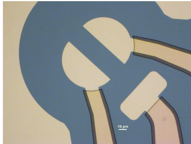
Figura 206 Imagem ótica da litografia das múltiplas camadas.
