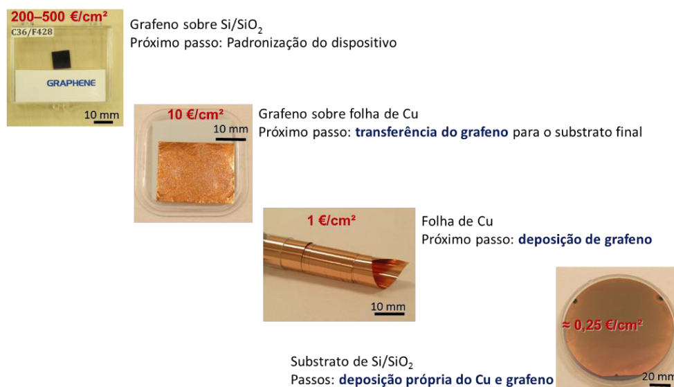
Figura 92 Custos para grafenos de diversas origens: 1. Grafeno transferido comercialmente, 2. Grafeno depositado comercialmente, 3. Grafeno crescido no INL, 4. Cobre e grafeno crescido no INL.
