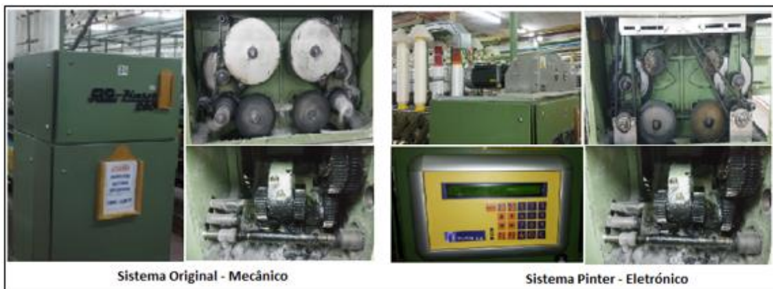
Figura 2.7: Filatório Fasa-Zinser modelo 260 (original e adaptado com sistema Pinter) 14
