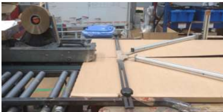
Figura 60 - Sistema de fecho das abas laterais da caixa de cartão
