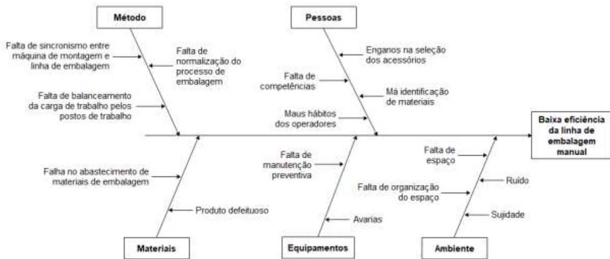
Figura 39 - Diagrama de causa-efeito para a baixa eficiência da linha de embalagem manual
