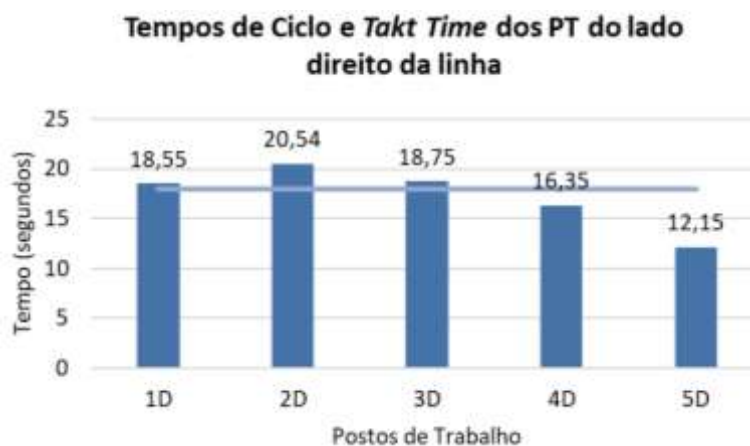
Figura 61 - Tempos de ciclo e takt time dos PT do lado direito da linha de embalagem
