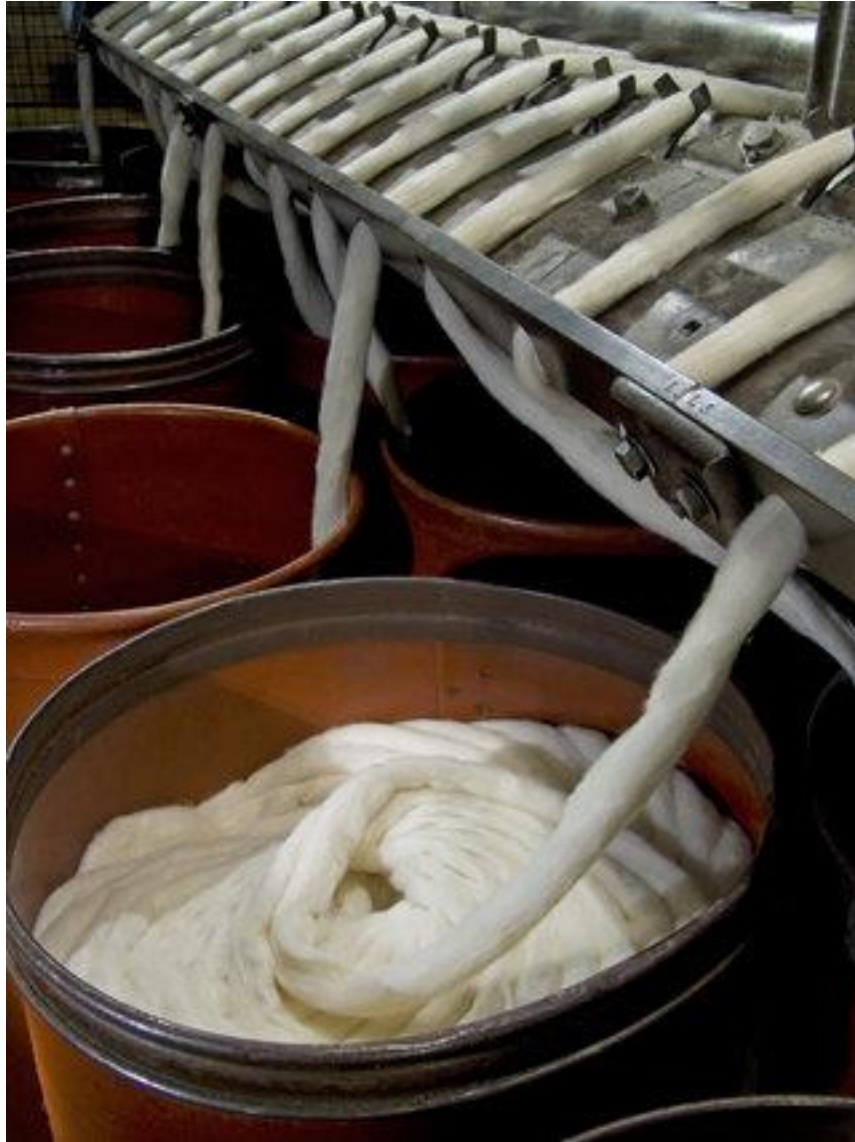
Figura 5: Fibras de algodão sob a forma de fita, em lata de transporte entre máquinas.
