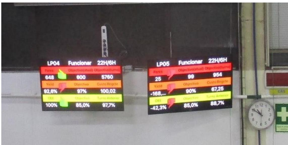
Figura 107: Sistemas Andon instalados para a monitorização da atividade produtiva.
