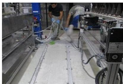
Figura 56: Limpeza da estrutura do equipamento por sopro de ar.
