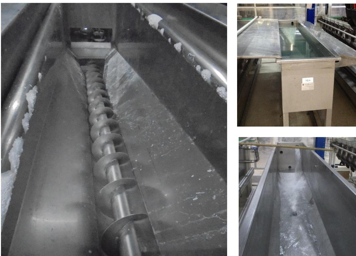
Figura 83: Tanque TQ6 com sistema de remoção automático de resíduos de sulfato (à esquerda). Tanque TQ6 original (à direita).
