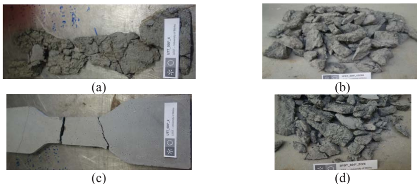
Figura 2. Modos de rotura: (a) e (b) rotura explosiva para 500 °C de provetes para ensaios de tração e flexão, respetivamente; (c) fissuração para 600 °C em provetes para ensaios de tração, e (d) rotura explosiva a 600 °C para provetes de flexão.
