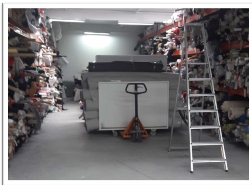
Figura 37. Inexistência de local apropriado para guardar o escadote e o porta-paletes
