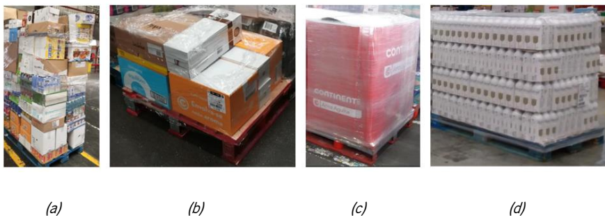
Figura 3.6 - Tipos de unidades de movimentação expedidas: (a) paleta de picking ; euro, (b) meia paleta de picking , (c) meia paleta completa e (d) paleta completa euro
