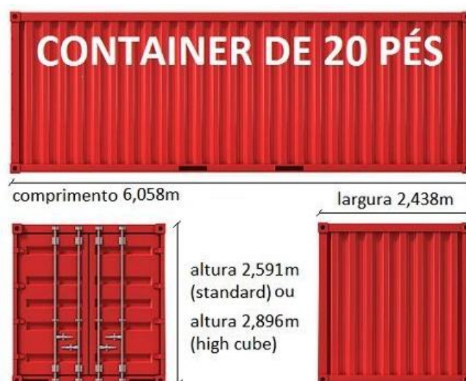
Figura 96: Medidas de um container de 20 pés
