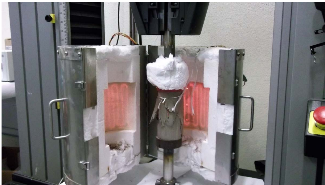
Figura 3: Provete após rotura e abertura do forno.
