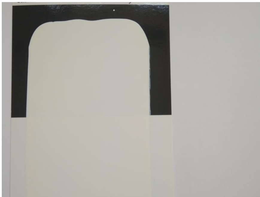
Figura B2 - Esmalte 25 após ensaio estabilidade acelerada, aplicado em carta leneta com uma espessura de 200 \mu\text{m} .
