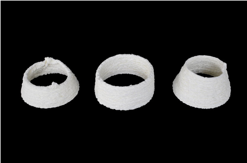
Figura 4.37. Primeiro teste de impressão, cilindro e dois cones truncados. Observação do comportamento da mistura B.
