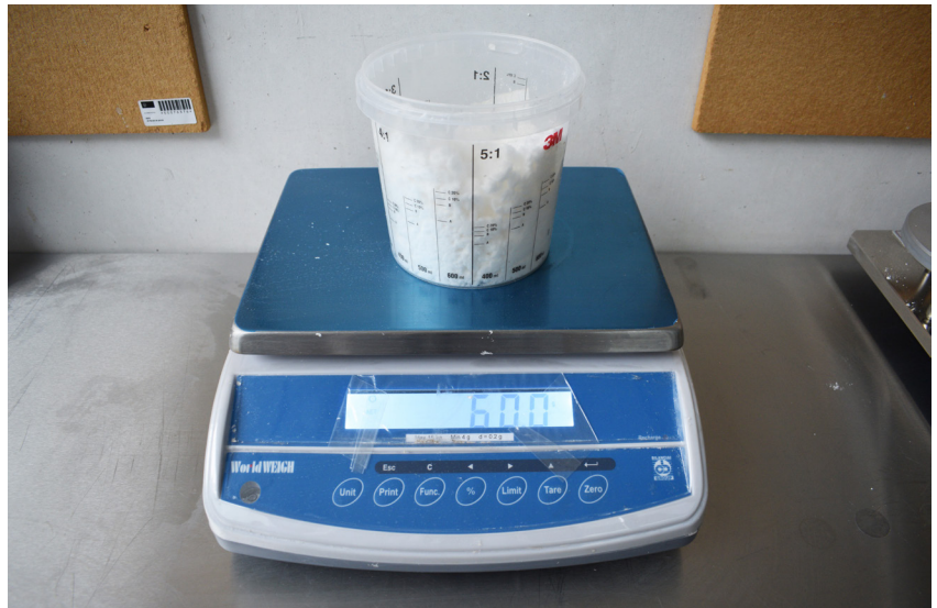
Figura 4.30. Pesagem de 60gr de celulose em pó.
