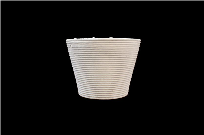
Figura 4.81. Secagem do cone truncado com 70° de curvatura. Fabricação do modelo com a mistura de pasta cerâmica, argila do tipo GRÉS 130 MP, sem celulose.
