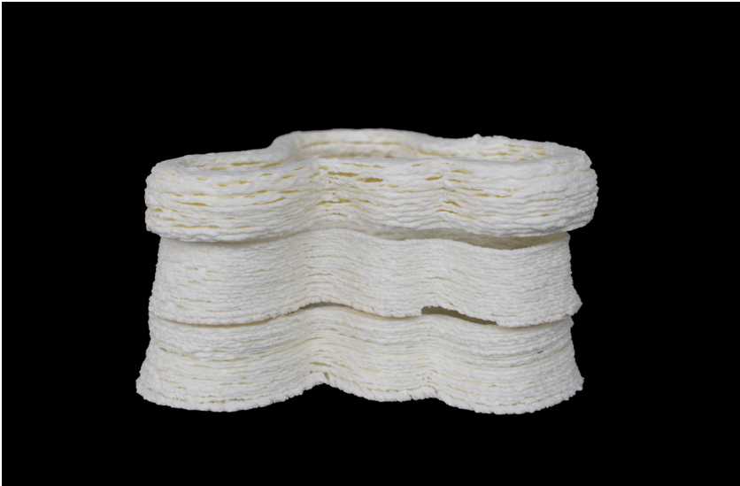
Figura 4.44. Secagem do modelo de estudo impresso AM Aalto, retração do material, camada a camada. Variação do bico de extrusão e paredes. Peça superior, parede simples com bico de extrusão de 10mm, peça central, parede simples com bico de extrusão de 3mm, peça inferior, parede dupla com bico de extrusão de 3mm.
