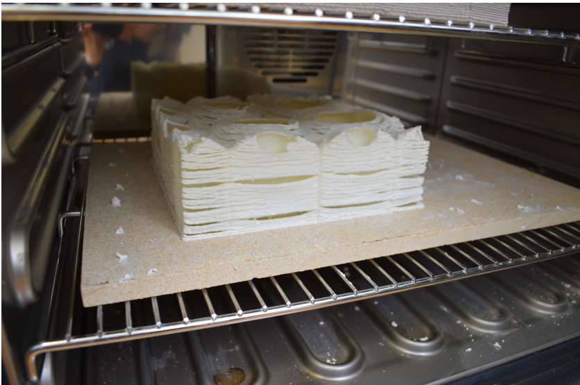
Figura 4.46. Laminação do modelo de estudo Alveolus após secagem em estufa. Observação da retração das diferentes camadas, intensificação da laminação nas paredes simples. Deformação com maior visibilidade nas paredes simples, deformação com menor visibilidade nas paredes duplas.
