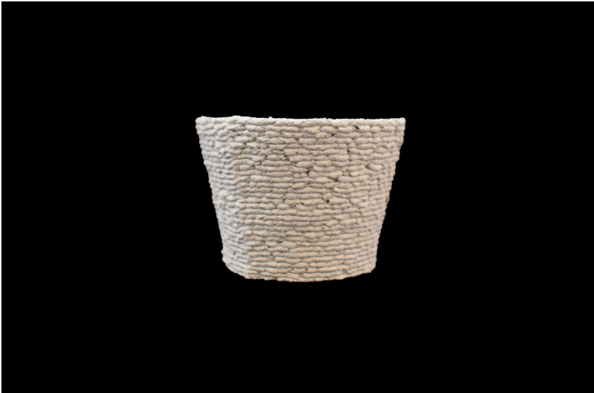
Figura 4.106. Secagem do cone truncado com 70° de curvatura. Fabricação do modelo com a mistura de pasta cerâmica, argila do tipo GRES 130 MP e 5% de pasta de celulose em pó, mistura 3.
