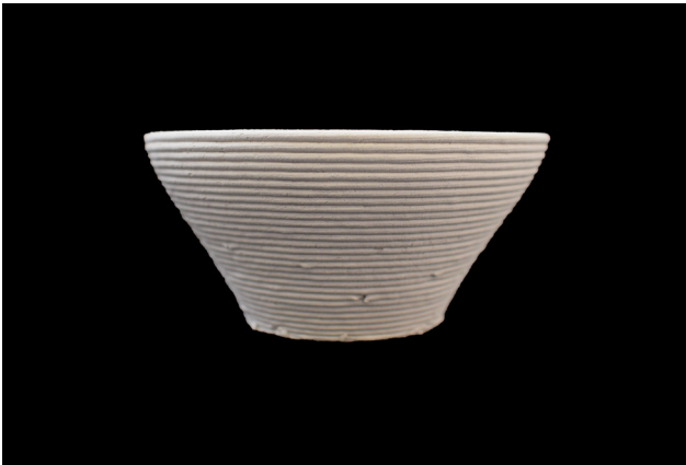
g. Cone truncado com 45° de curvatura
