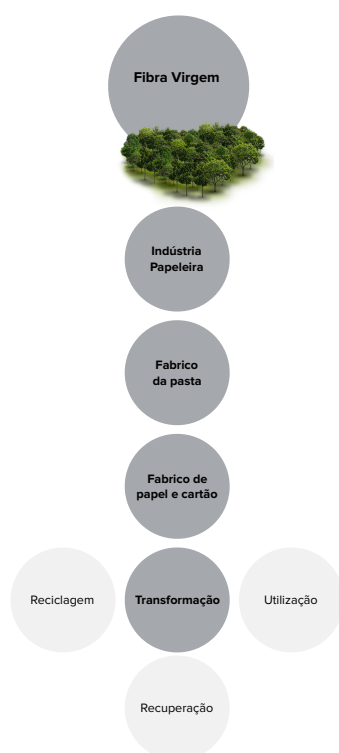
Esquema 3.01. Esquema exponenciando o valor da fibra virgem para a produção da celulose e do papel, tendo em conta as suas fases de transformação.
