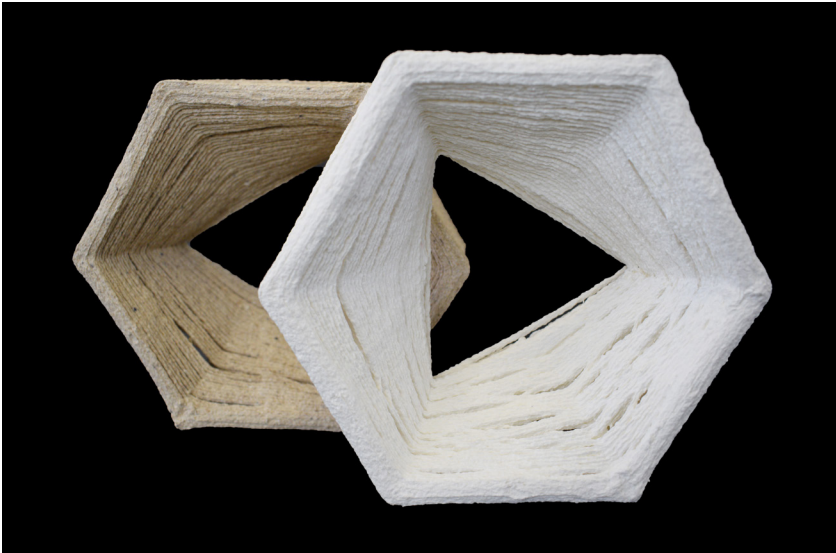
Figura 5.49. Acabamento das peças em celulose, após a secagem.
