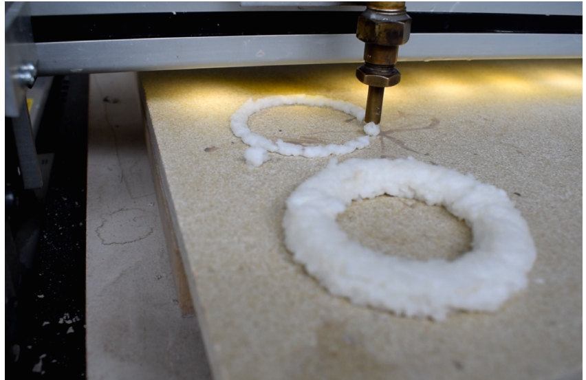
Figura 4.22. Impressão do primeiro teste realizado para comprovação da mistura A.
