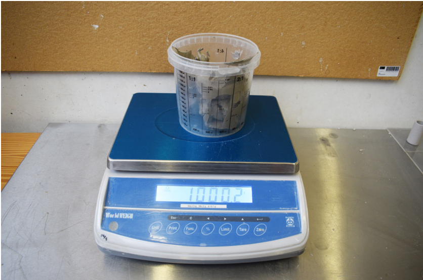
Figura 4.73. Pesagem de 1000gr de pasta cerâmica e anexação da água em falta para obtenção do teor de humidade pretendido.
