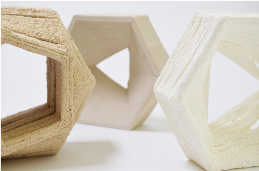
Figura 5.71. Peça final, observação da peça inferior — com abertura triangular — produzida com a mistura B.
