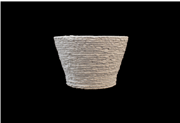
c. Cone truncado com 25° de curvatura
