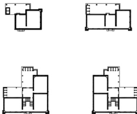
Figura 6 - Planta das diferentes variações tipológicas de uma, duas (cima, esquerda para a direita, respetivamente), cinco e seis salas (baixo, da esquerda para a direita, respetivamente) (reproduzido de Carvalho, Carla 2013).
