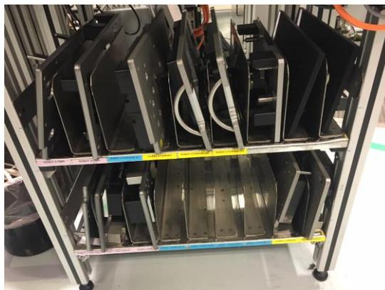
*Figura 31: Etiquetas nas prateleiras onde os dispositivos permanecem armazenados (uma cor diferente para cada produto)*
