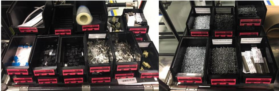
*Figura 34: Etiquetas nas caixas de abastecimento de componentes (uma cor diferente para cada produto)*
