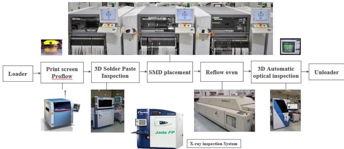
Figura 11: Esquema das fases do processo SMT (Aptiv, 2019)
