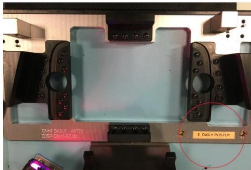
*Figura 35: Etiqueta de identificação do dispositivo (uma cor diferente para cada produto)*
