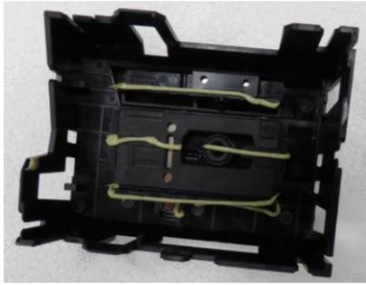
Figura 11- Lubrificação em linha
