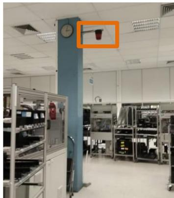
*Figura 40- Alerta luminoso para paragens por falta de material*
