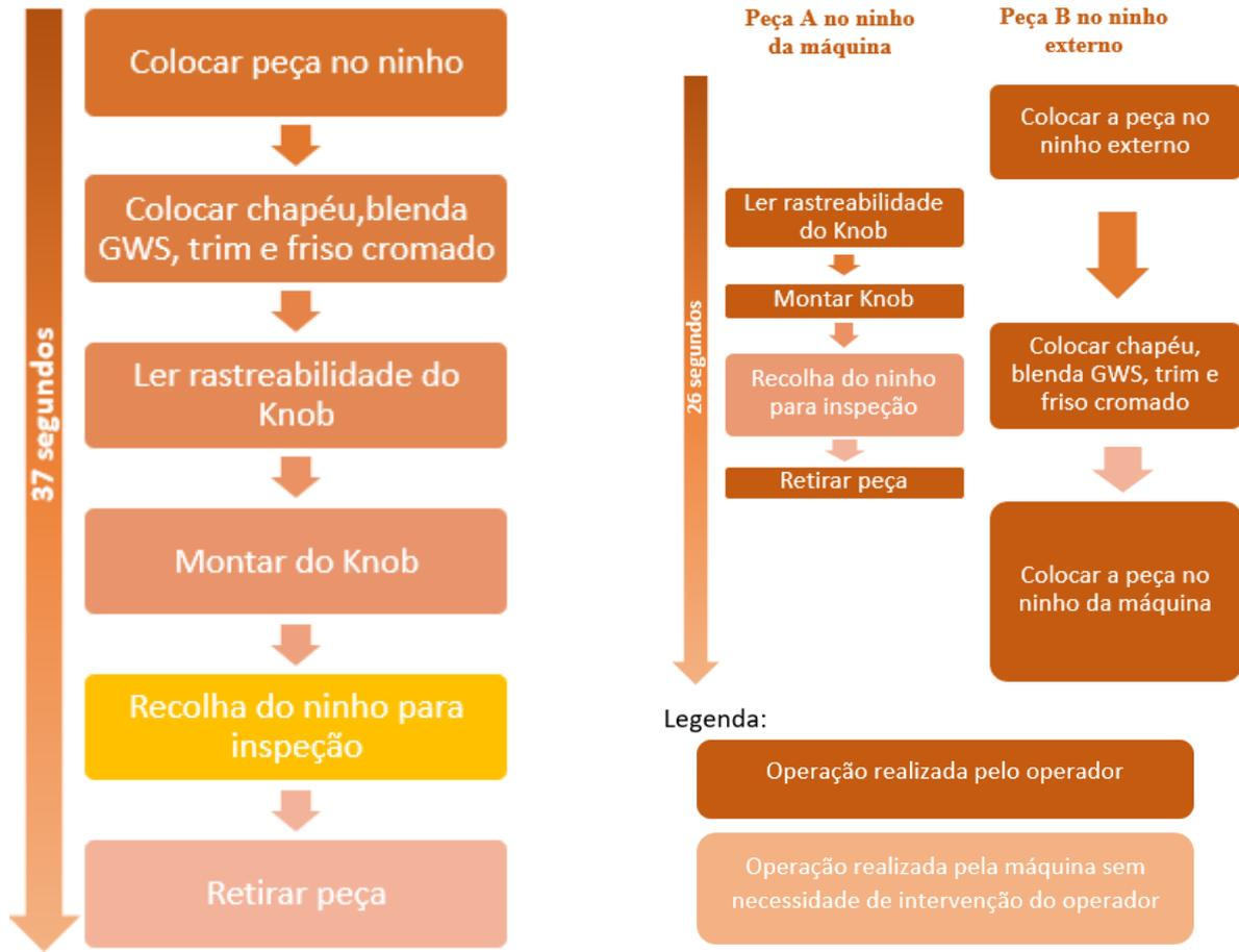
Figura 30- Processo antes (lado esquerdo) e após a adição do ninho externo da OP280 (lado direito)
