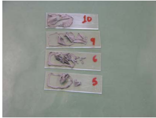
Figura 4.30: Amostras de material curado com carga de Carboneto de Tungstênio de diferentes granulometrias. Amostras 5 e 6 (granulometria de 2,5 \mu\text{m} ) e amostras 9 e 10 (granulometria de 6 \mu\text{m} ).
