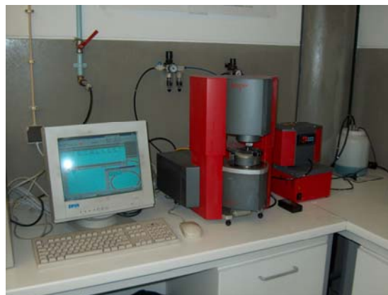
Figura 4.31: Reômetro de pratos cilíndricos concêntricos da marca Streestech (viscosidades a variar de 0.1 a 106 Pa.s).
