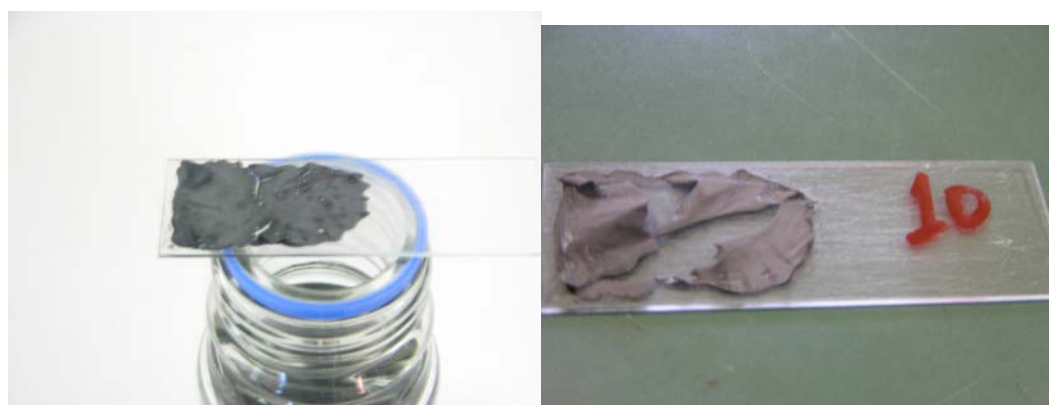
Figura 4.29: Amostra de material curado com carga de Carboneto de Tungsténio de granulometria 6 \mu\text{m} .
