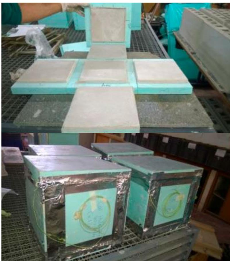
Figura 1. Células de teste utilizadas para avaliação do desempenho térmico das argamassas.
