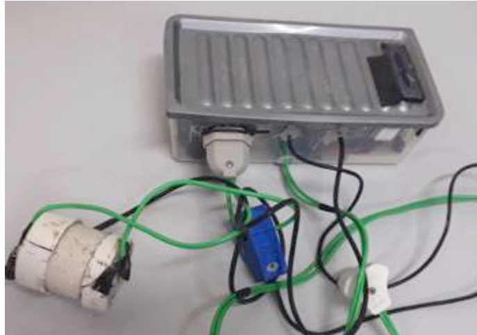
Figura 2 – Foto do aparato em seu estado final, mostrando o molde do lado esquerdo, o aparato com tela na parte superior e o sensor de temperatura SCT013-010 no centro (azul).
