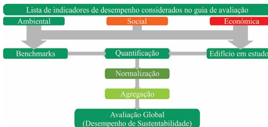
Figura 3 - Estrutura da metodologia SBTool PT
