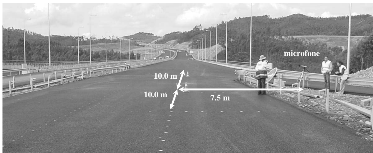
Figura 1 – Esquema de localização do microfone
