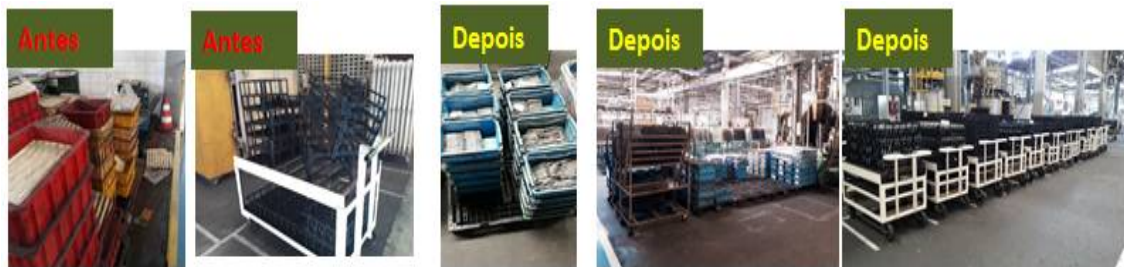
Figura 58 - Comparativos de antes e depois da organização na área de stock de peças tratadas.
