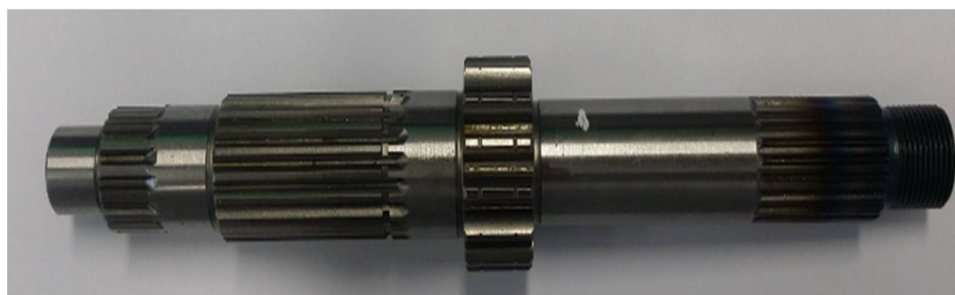
Figura 16 – Foto de eixo GW-N após todo processo de Tratamento Térmico.
