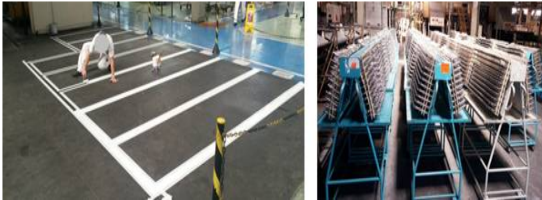
Figura 57 - Marcação do piso da área do stock para limitar quantidade de peças.
