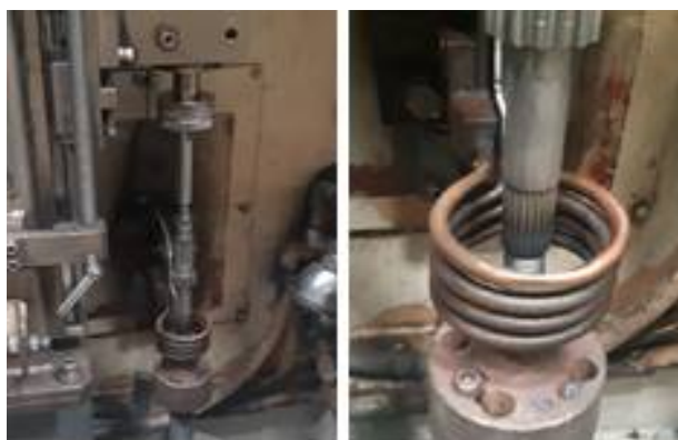
Figura 26 – Eixo posicionado na bobina de indução.
