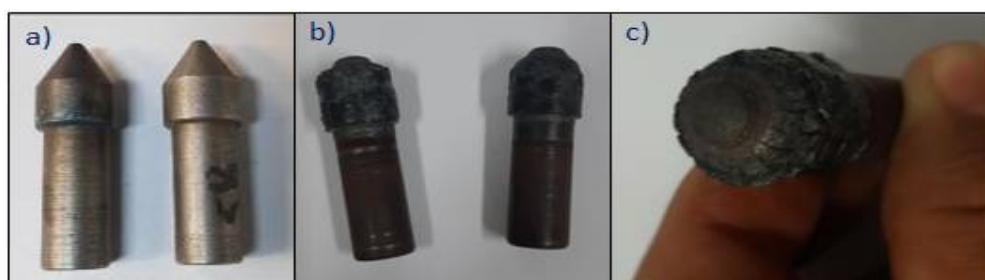
Figura 41 - Pontas utilizadas para fixar eixo na indutora: a) pontas novas, b) e c) pontas gastas após 3 meses de uso.
