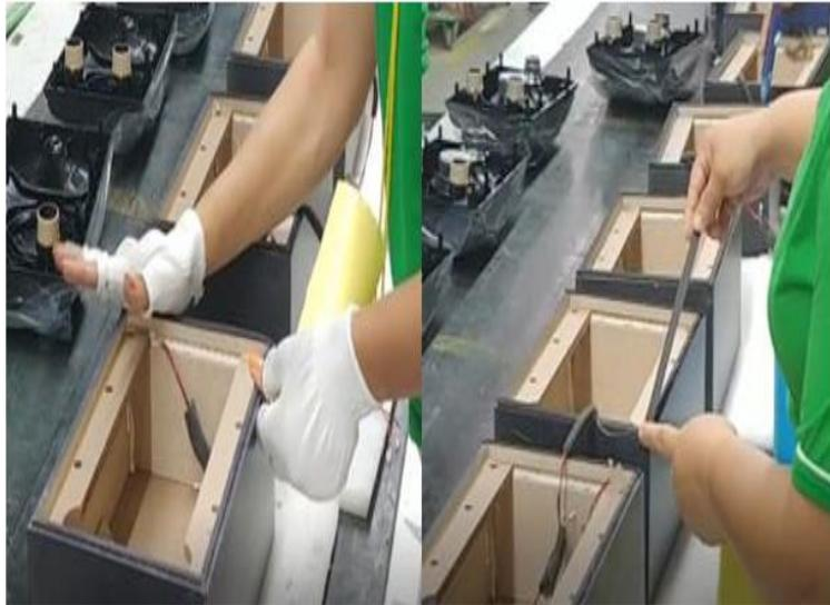
Figura 37. Processo Manual da Aplicação de Vedação.
