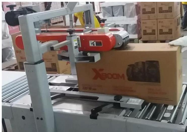
Figura 49. Proposta de Aplicação de Máquina 3M.
