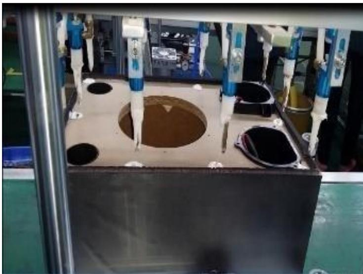
**Figura 36.** Automatização de Aplicação de Cola no Baffle.
