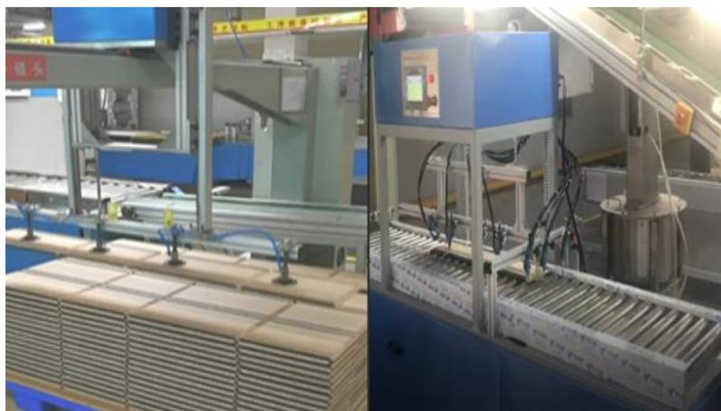
**Figura 34.** Proposta de Automatização do Posto de Alimentação e Aplicação de Cola na Madeira.
