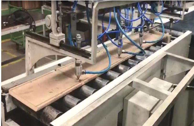
**Figura 59.** Automação no Processo de Aplicação de Cola.
