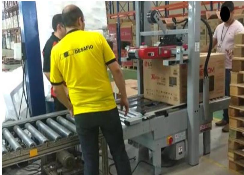
**Figura 61.** Instalação da Máquina 3M linha 1.
