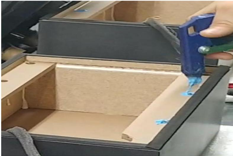
**Figura 35.** Aplicação de Cola Manualmente.
