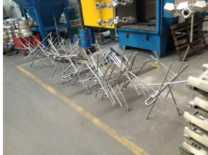
Figura 53 - Área de estacionamento dos ganchos da granalhagem
