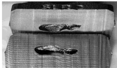
Figura 29 - Defeito por encolhimento (Rechupe)
