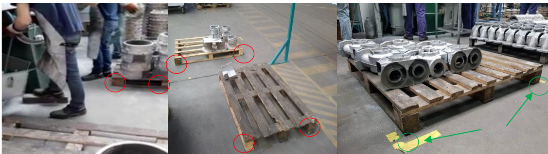
Figura 102 - WIP antes da implementação dos 5S (1ª e 2ª figuras) e após (3ª figura)
