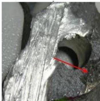
Figura 30 - Defeito do material de moldação (Rebarbas)
