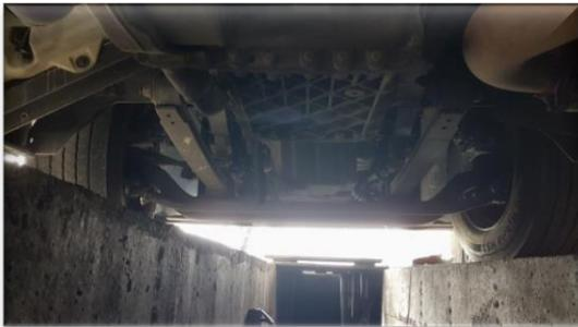
Figura 18. Exemplo de duas molas que compõe uma suspensão de *chassis*.
