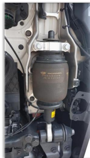
Figura 17. Exemplo de um pneumático que compõe uma suspensão de cabine.
