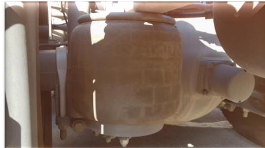
Figura 19. Exemplo de um pneumático que compõe uma suspensão de *chassis*.
