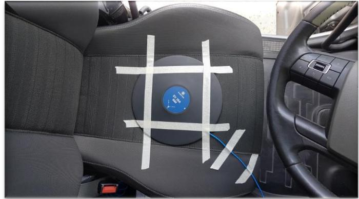
Figura 11. Localização e fixação do acelerómetro tri-axial no assento de um veículo de teste.
