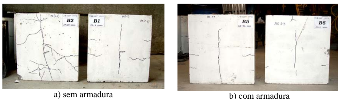
Figura 9 - Fissuração das lajes em corpos-de-prova ensaiados.
