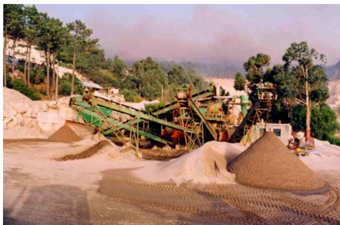
Fig. 8 - Instalação de lavagem de areia na Pedreira de Vila Praia de Âncora
