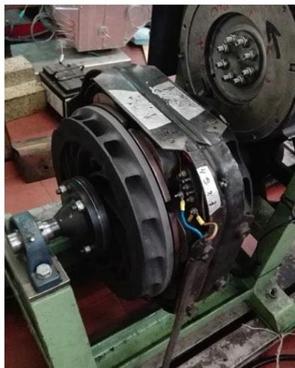
Figura 10- Freio de correntes de *Foucault* existente no LaMoTA
