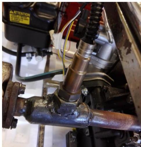
Figura 30 - Instalação da sonda lambda
