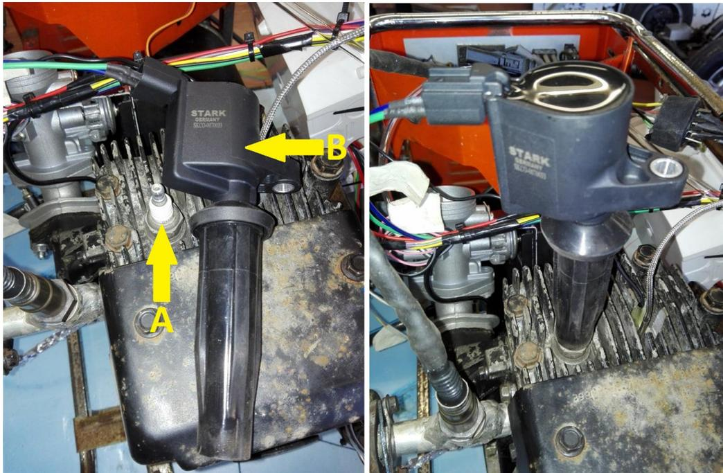
Figura 53 –Vela de ignição fixa no motor (A) e bobina de ignição (B), à esquerda, e bobina de ignição encaixada na vela de ignição, à direita
