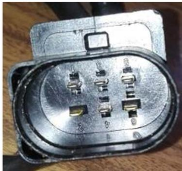
Figura 32 - Conector da sonda lambda
