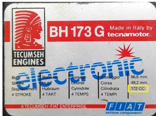
Figura 56 - Placa com informações acerca do motor (cilindrada assinalada a amarelo)
