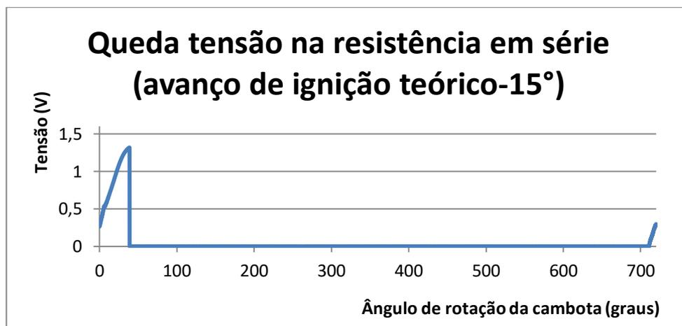
Figura 96 - Queda de tensão na resistência (em série com primário da bobina de ignição) em função do ângulo de rotação da cambota para um avanço de ignição de  $15^\circ$
