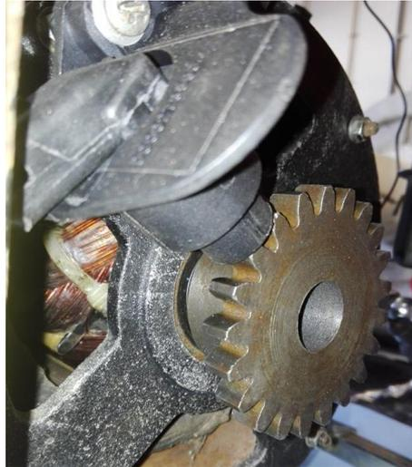
Figura 35 - Sensor de rotação da cambota (do tipo indutivo) e roda dentada
