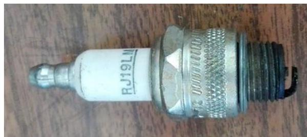
Figura 90 - Vela de ignição RJ19LM
