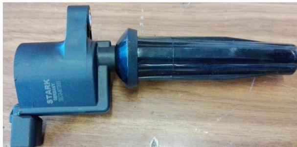
Figura 47 - Bobina de ignição STARK (Referência: SKCO-0070033)
