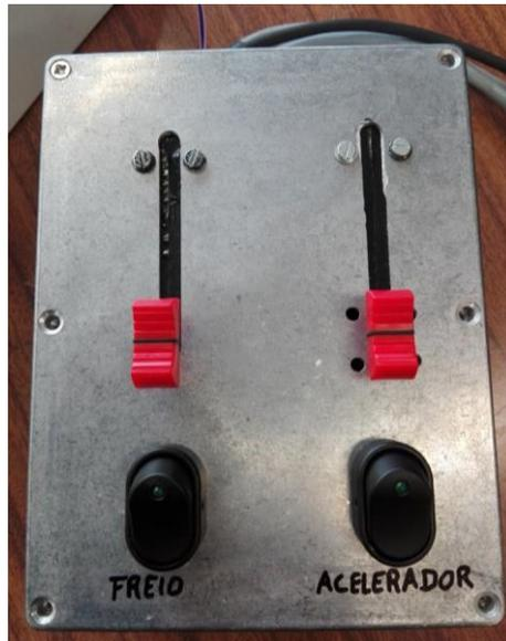
Figura 91 – Tampa da caixa metálica usada para alojamento do arduino e instalação de interruptores e potenciômetros
