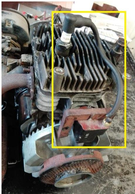
Figura 14 - Sistema de ignição utilizado pelo motor
