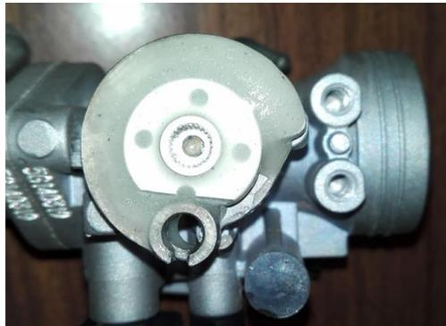
Figura 78 - Peça de fixação do servo colada na roldana
