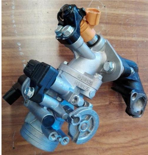
Figura 13 – Conjunto de corpo de borboleta e coletor de admissão utilizado no trabalho
