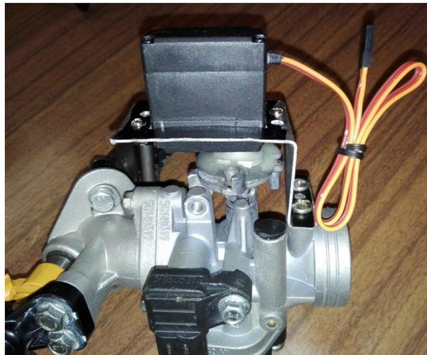
Figura 79 - Acoplamento entre servo e eixo da borboleta
