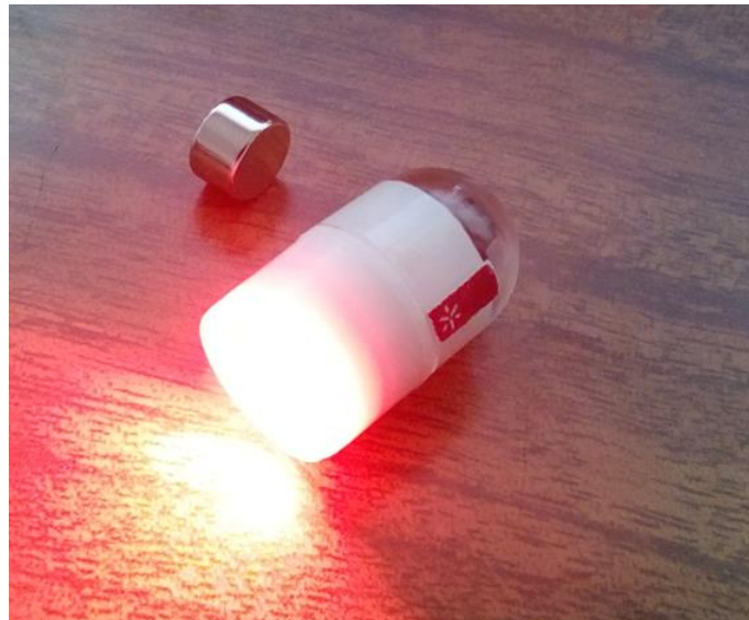
Figura 4.19 – Imagem real do protótipo da nova cápsula para a realização da TFD. Fonte de luz vermelha ativada na presença de campo magnético.
