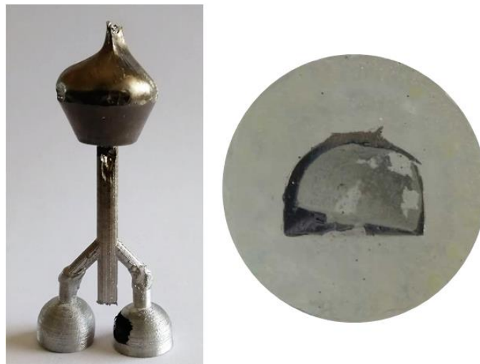
Figura 4.31 – Exemplos de reservatórios com defeitos resultantes da utilização de um furo de diâmetro reduzido.
