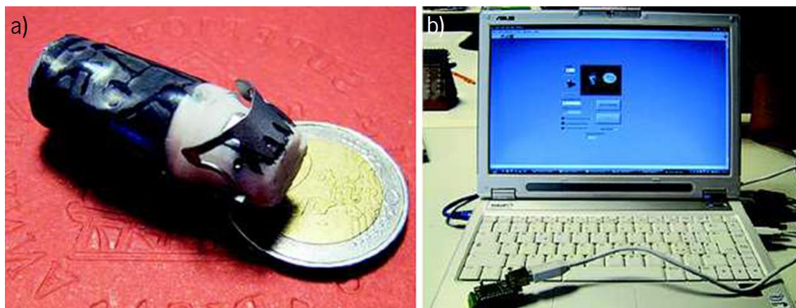
Figura 1.8 – a) Cápsula equipada com uma garra cirúrgica desenvolvida por P. Valdastrì et al. ; b) interface homem-máquina que permite a comunicação sem fios com a cápsula [43].
