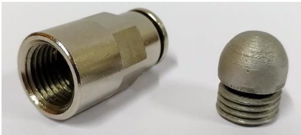
Figura 4.37 – Reservatório final utilizado nos ensaios de pressão (direita) e conector do aparato experimental (esquerda).
