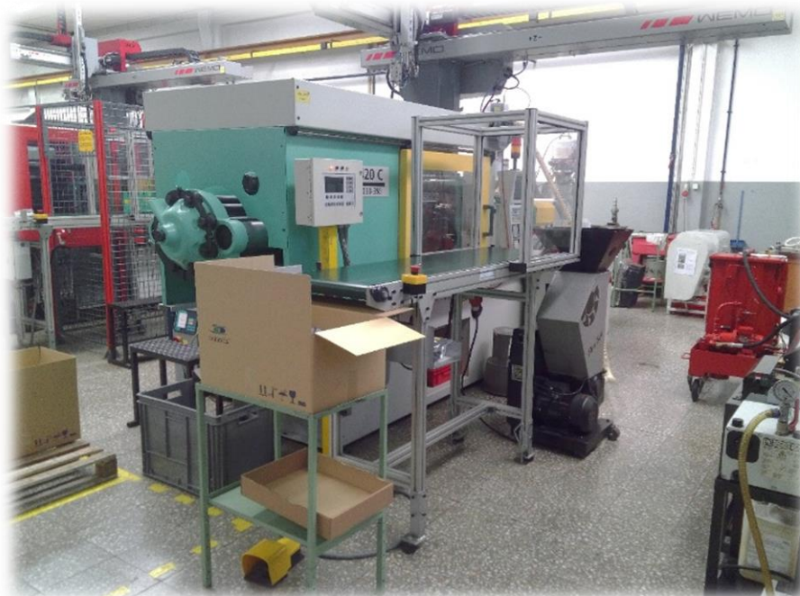
Figura 31 - Máquina de injeção utilizada;
