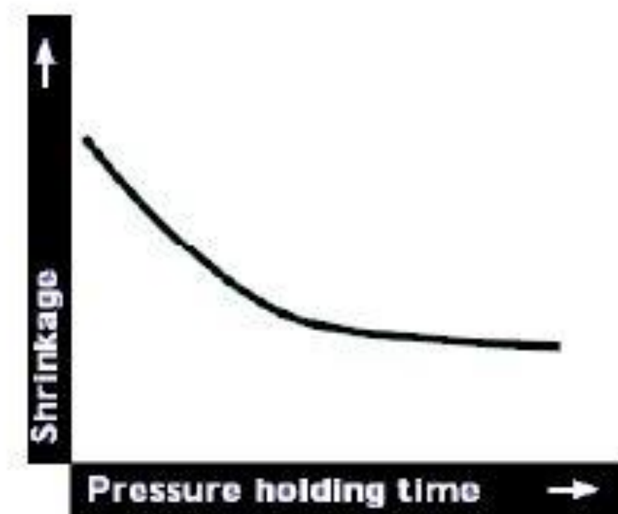
Figura 15 – Gráfico da Contração vs Segunda Pressão; (adaptado de (16))
