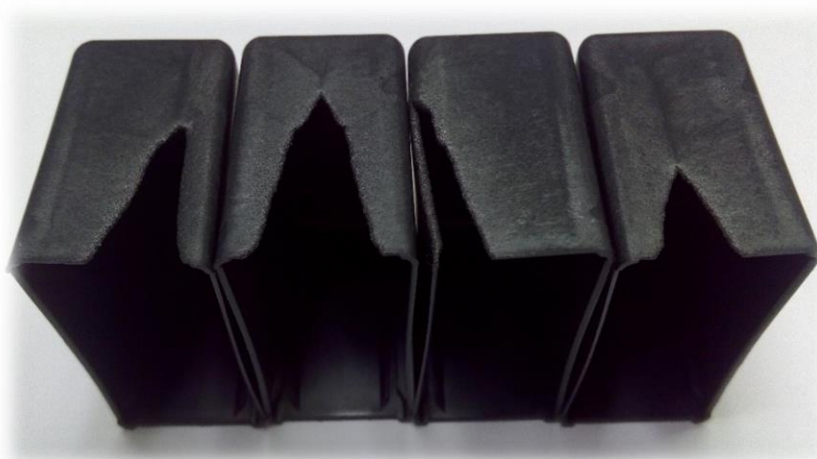
Figura 28 - Injeção incompleta (o material utilizado na injeção destas peças não é o mesmo que o material em estudo);
