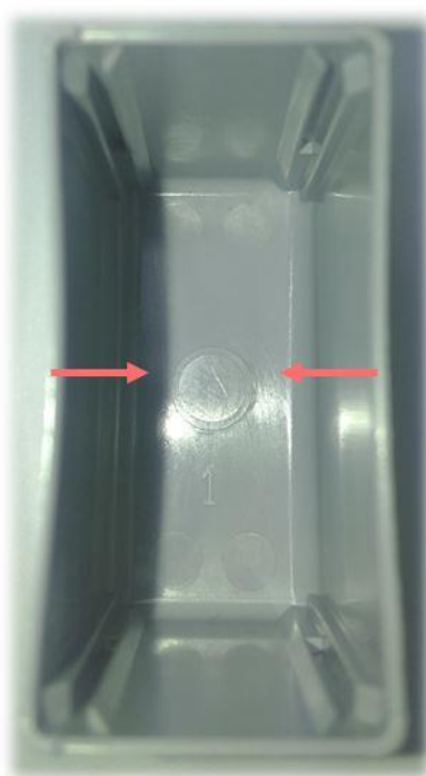
Figura 24 - Representação do empeno das paredes laterais;
