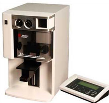
Figura 18: Contador de células eletrónico Z2 da Beckman Coulter utilizado para a contagem de células de levedura. (Fonte: referência 67)
