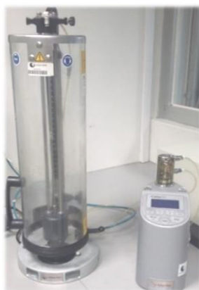
Figura 16: Carbo QC , equipamento utilizado para medição da concentração de CO 2 .
