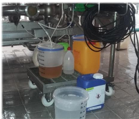
Figura 20: Imagem fotográfica da colocação da enzima \alpha -acetolactato descarboxilase na linha de arrefecimento do mosto.
