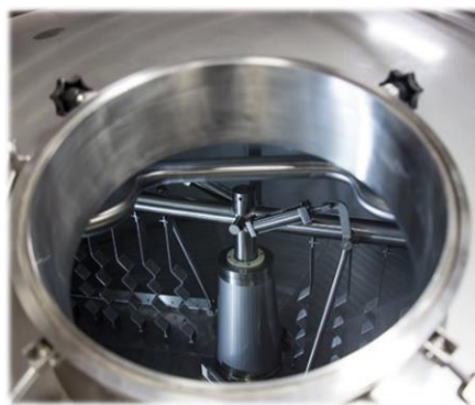
Figura 7: Exemplo de uma cuba filtro. (Fonte: referência 26)
