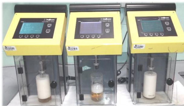
Figura 14: Equipamento utilizado na determinação da estabilidade de espuma pelo método NIBEM .
