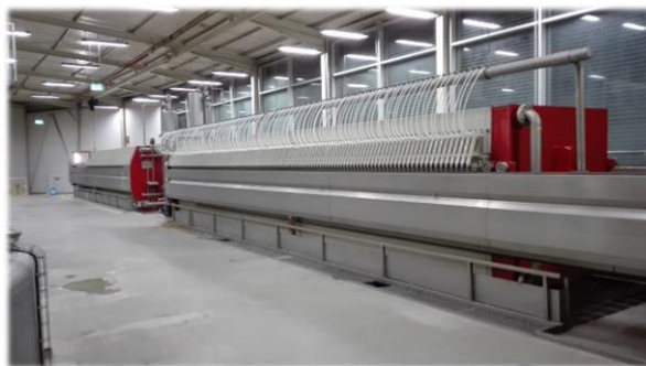
Figura 8: Filtros de placas Meura 2001 presentes na Super Bock Group .
