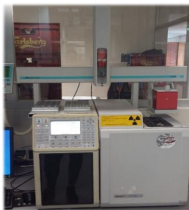
Figura 15: Equipamento utilizado na determinação da concentração de diacetil por Cromatografia Gasosa.
