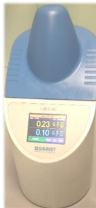
Figura 17: Aparelho LabScat da Sigrist utilizado para medição das turvações e da estabilidade coloidal.
