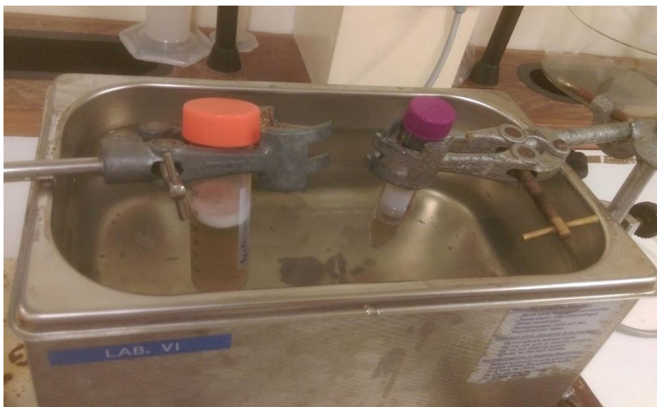
Figura 3.5 : Preparação da reação com CDI em banho de ultrassons para a síntese de nanopartículas cobertas com surfactantes.
