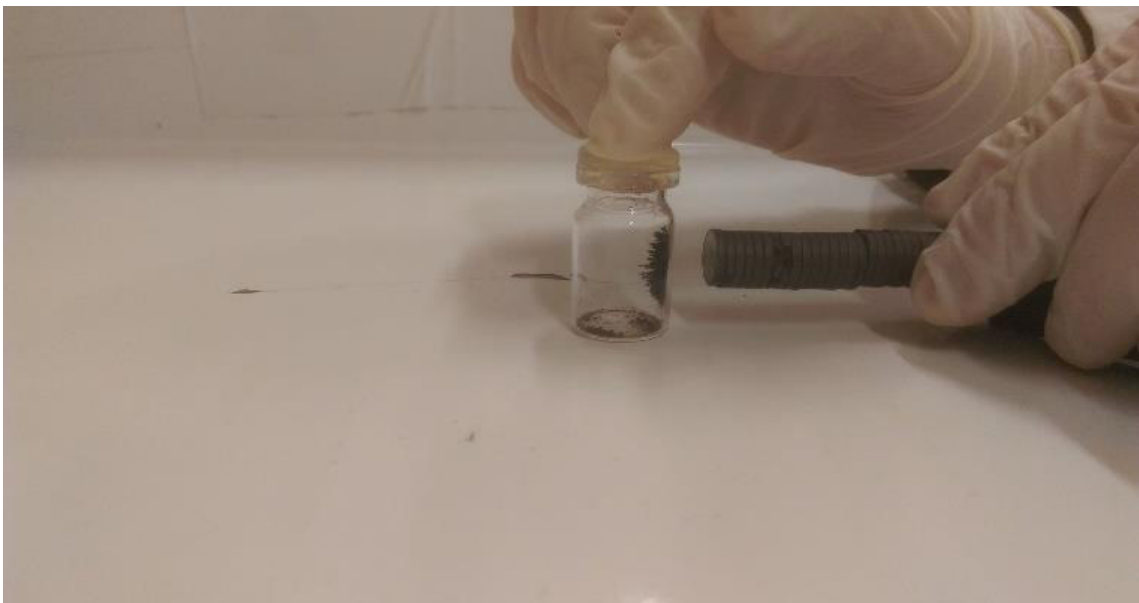
Figura 4.8: Nanopartículas magnéticas na presença do campo magnético externo
