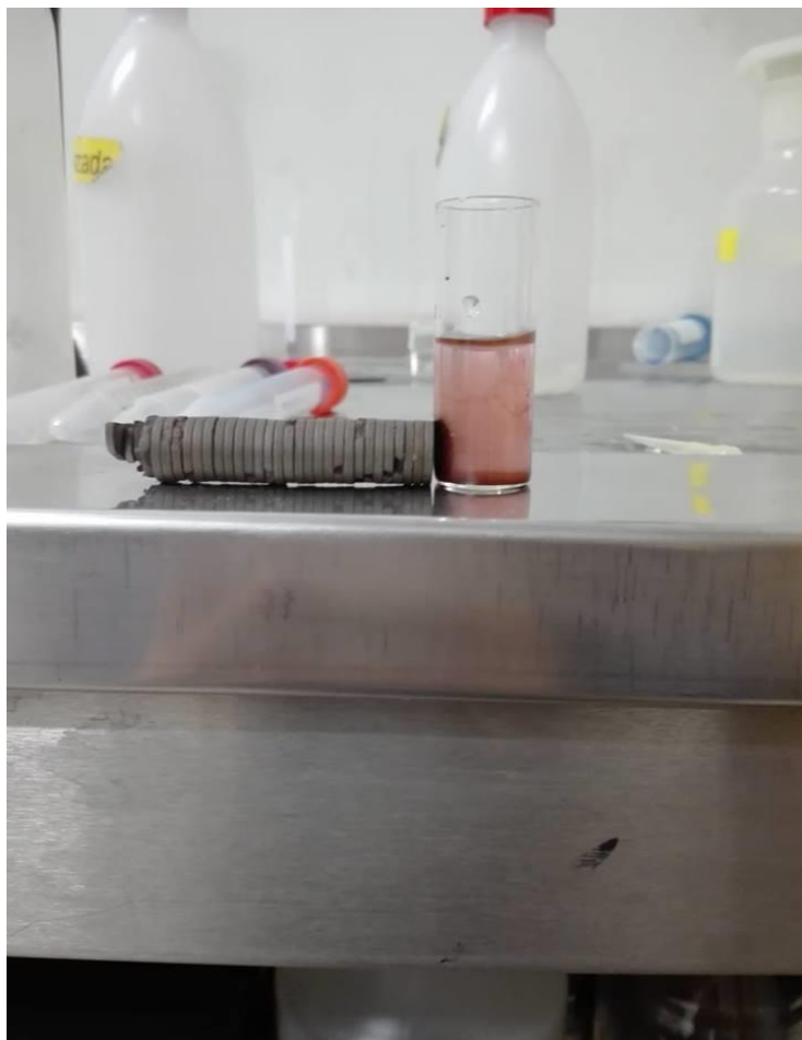
Figura 4.10: Nanopartículas magnéticas numa solução de rodamina B na presença de um campo magnético externos
