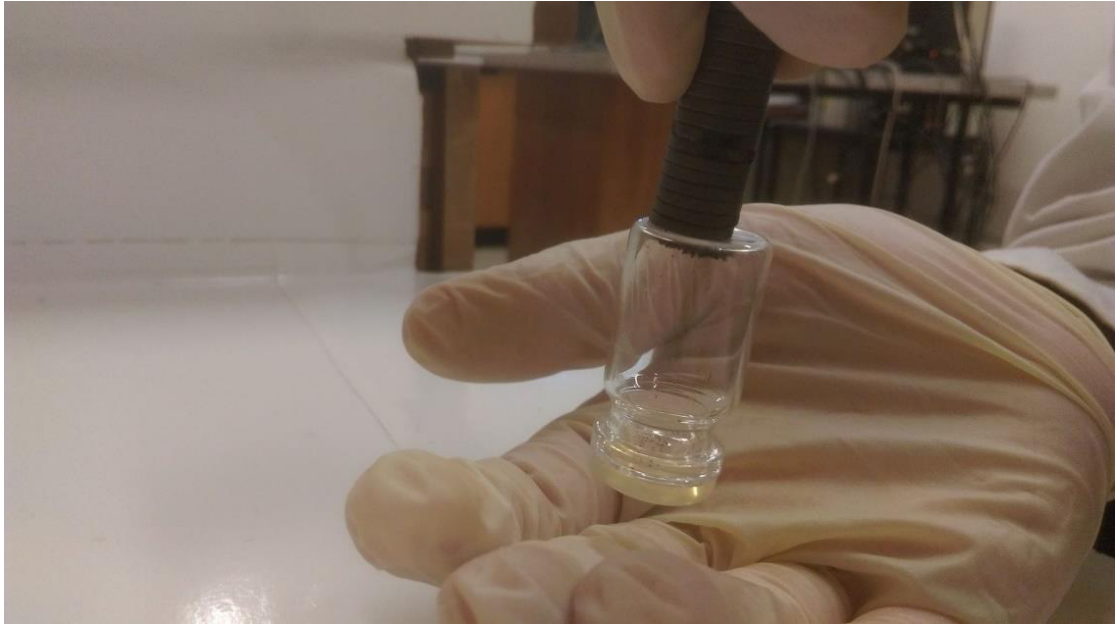
Figura 4.9: Nanopartículas magnéticas na presença do campo magnético externo (2)
