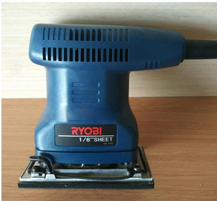
**Figura 4.14** Lixadora Orbital Ryobi, Modelo S550.
