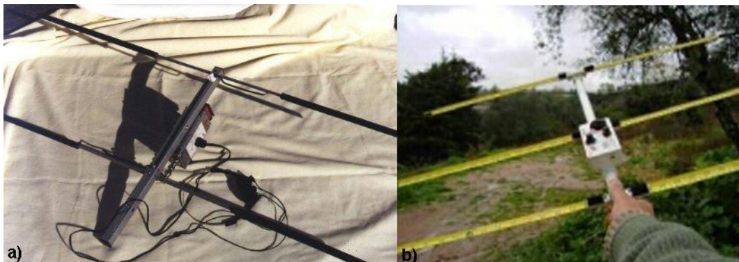
Fig. 34 - Exemplos de Sniffers com antenas Yaggi
