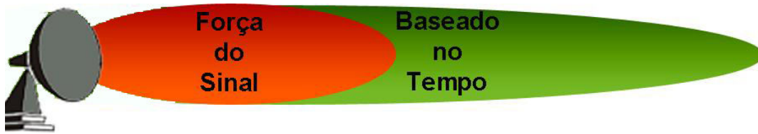
Fig. 10 – Alcance de um receptor usando duas estratégias de rádio-localização
