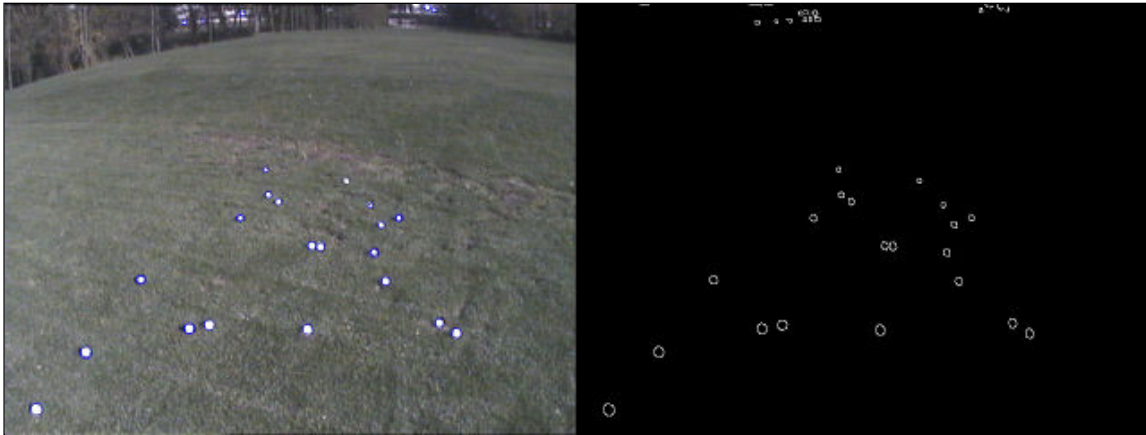
Figura 33 Imagem com resultado final do processamento com aplicação do filtro "simple blur" 3x3 e detecção de contornos com parâmetros 325, 400,3 – resolução 640x480.
