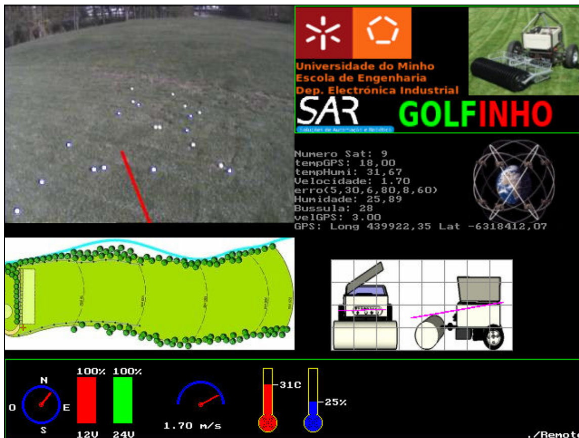
Figura 24 Interface gráfica do pcRemoto, com detecção de bolas e sensores em funcionamento
