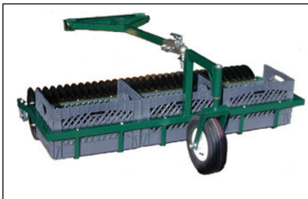
Figura 5 Sistema de reboque para recolha de bolas de golfe com máquinas de motor de combustão comercializado pela Rangemart
