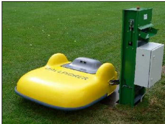
Figura 6 Robô que apanha as bolas de golfe por varrimento de toda a área, estação de carga de baterias e descarga de bolas
