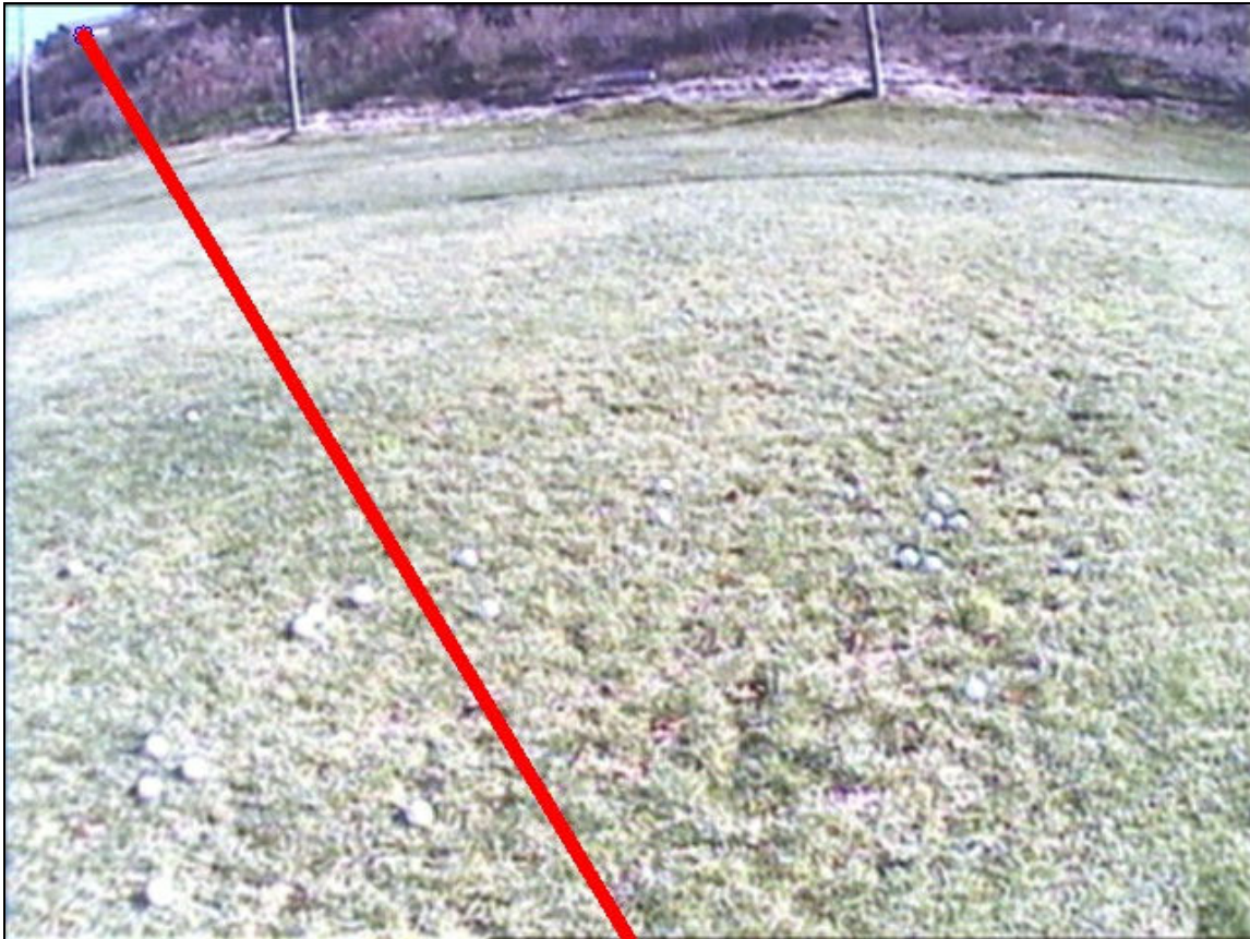
Figura 30 Detecção errada de bolas de golfe devido ao mau funcionamento dos sistemas de ajuste automático AGC e BLC e reflexos da relva.
