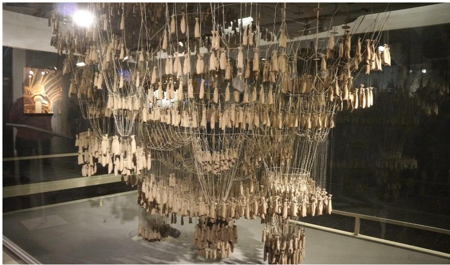
Figure 2.7- Colonia Güell, funicular three-dimensional model (N. M. Larsen, 2012)
