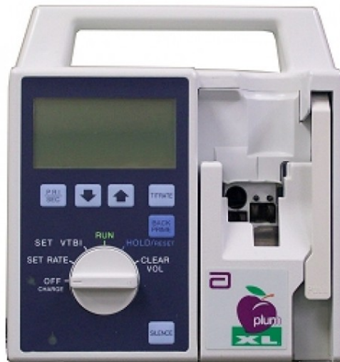
Figura 2-6: Bomba de infusão de mecanismo de cassete Plum® XL (retirado de: https://infusystem.com/sales-and-rental/equipment-catalog/product/40-hospira-plum-xl )
