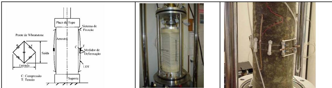
Figura 4 – Esquema de funcionamento e pormenor da utilização dos LDT's (UM).
