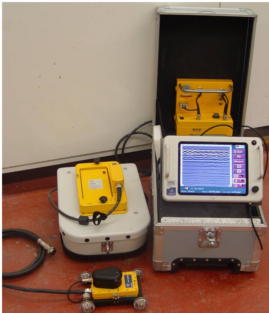
Figura 4 – Sistema de Radar de Prospecção Geotécnica do Departamento de Engenharia Civil da Universidade do Minho, incluindo unidade de controlo e gerador de sinal, e duas antenas.
