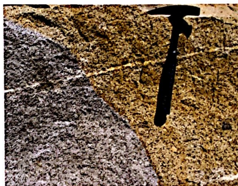
FIGURA 10. Granito de Santo Ovídio de cor amarelada devido à oxidação de minerais ricos em ferro (biotite e pirite)
