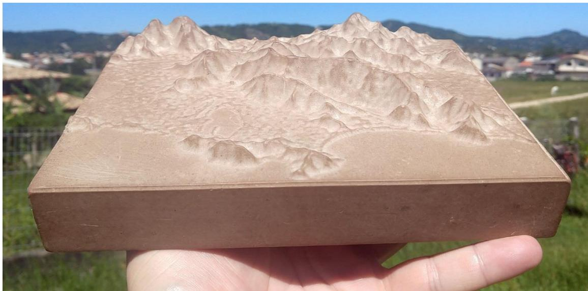
**Figura 5.** Maquete usinada em CNC na escala de 1/100.000 do município litorâneo de Garopaba, SC, com exagero vertical de 4,5. Neste protótipo é possível perceber os grandes lineamentos estruturais da Serra do Mar, com a resultante geomorfológica de formação da Planície Costeira.
