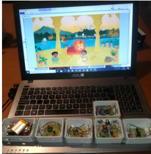
Figura 5.8. Funcionamento do sistema com o protótipo veroboard de teste.
