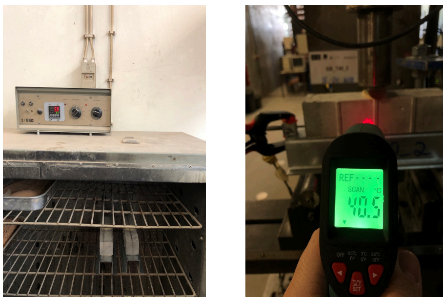
Figura 4.18 – Provete em estufa e durante ensaio a 40°C
