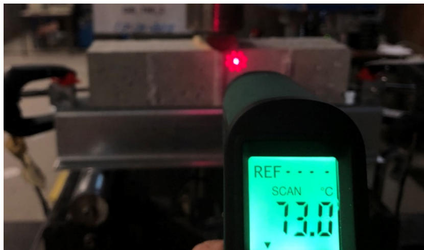
Figura 4.33 – Provete submetido a elevação de temperatura durante ensaio
