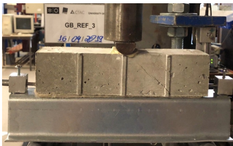
Figura 4.24 – Provelte GB_REF_3 durante o ensaio
