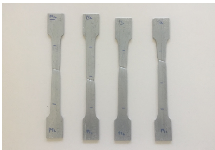
Figura 4.6 – Provetes após rotura ocorrida em ensaio de tração
