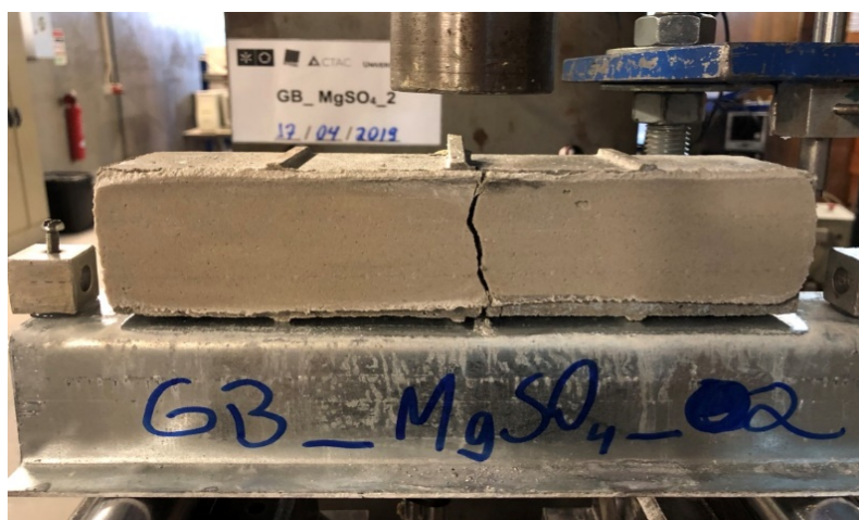
Figura 4.31 – Provete submetido ao ataque de MgSO_4 (30 dias) após o ensaio
