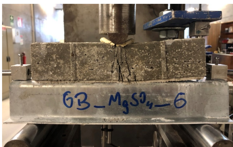
Figura 4.30 – Provete submetido ao ataque de MgSO_4 (60 dias) durante ensaio
