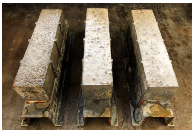
Figura 4.14 – Provetes após 60 dias em ataque de cloreto (NaCl) após serem lavados
