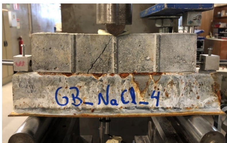
Figura 4.27 – Provetes submetido ao ataque de NaCl (60 dias) durante o ensaio
