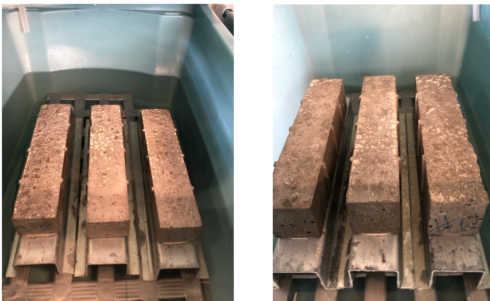
Figura 4.15 – Provetes submetidos a ataque de sulfato ( \text{MgSO}_4 )
