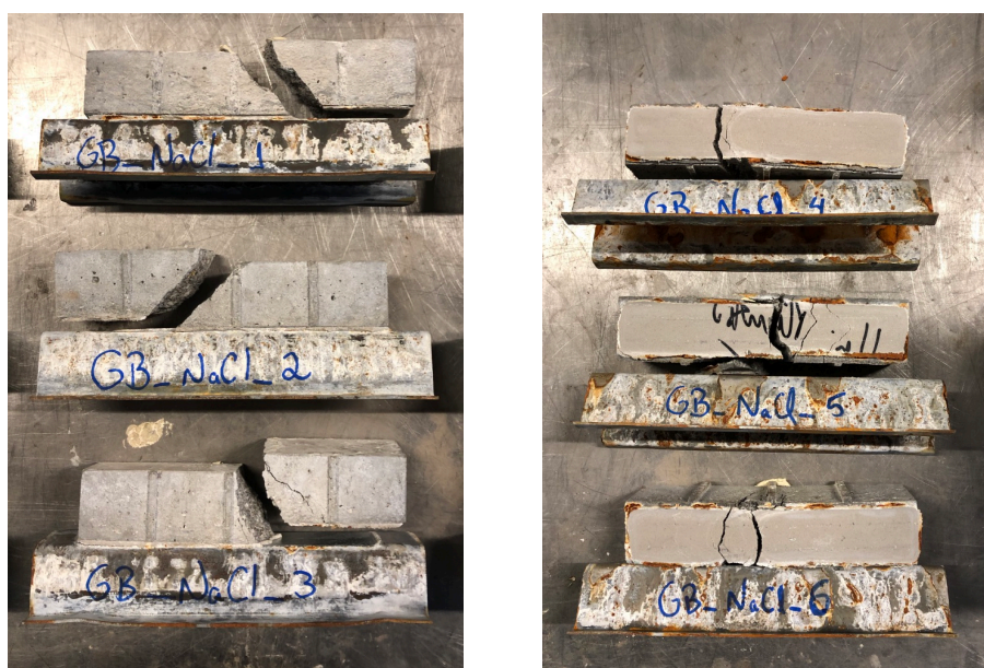
Figura 4.29 – Provetes submetidos ao ataque de NaCl após o ensaio
