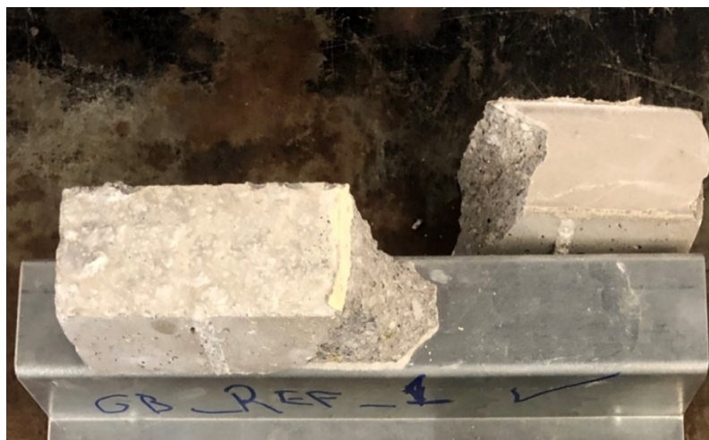
Figura 4.25 – Provete GB_REF_1 após rotura
