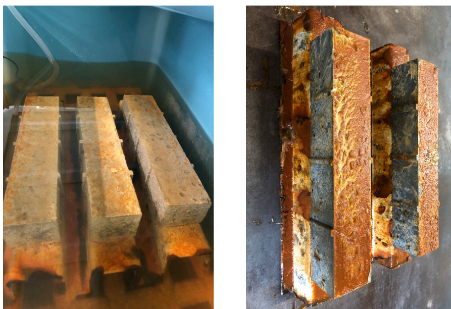
Figura 4.12 – Provetes submetidos a ataque de cloreto (NaCl)
