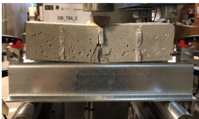
Figura 4.34 – Provete submetido a elevação de temperatura (após rotura)
