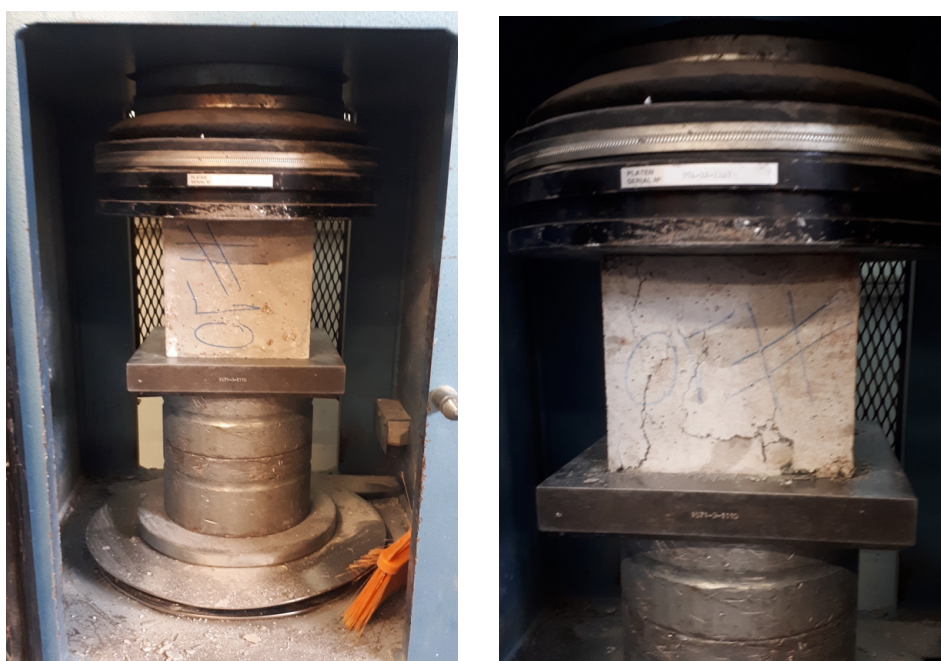
Figura 4.4 – Ensaio à compressão em cubos 150 \times 150 \times 150 mm, aos 7 dias
