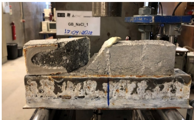
Figura 4.28 – Provede submetido ao ataque de NaCl (30 dias) após o ensaio
