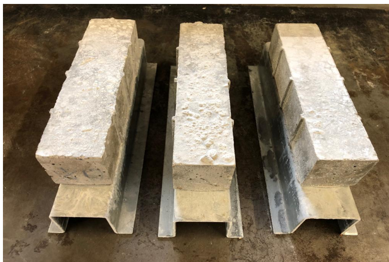
Figura 4.16 – Provetes após 30 dias em ataque de sulfato ( \text{MgSO}_4 )
