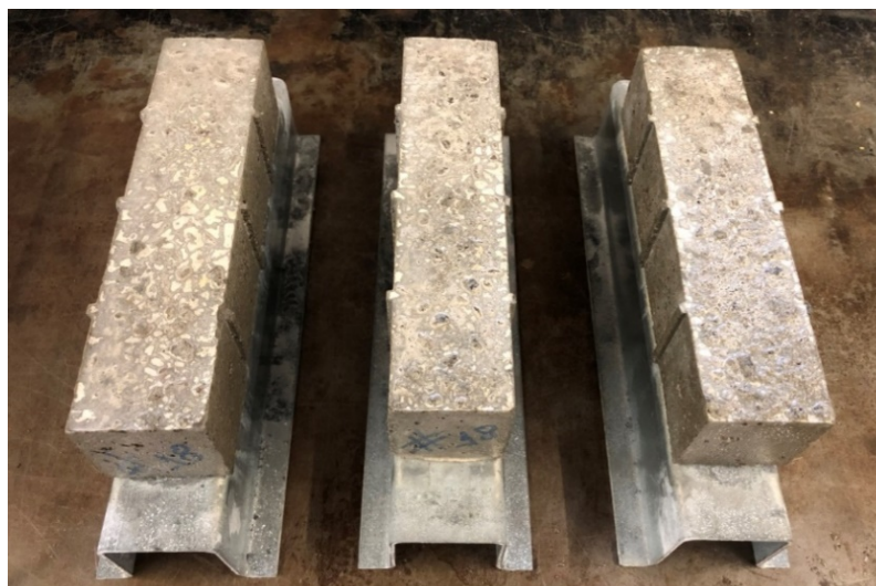
Figura 4.17 – Provetes após 60 dias em ataque de sulfato ( MgSO_4 )
