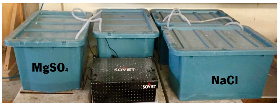
Figura 4.11 – Sistema automatizado para aplicação de ciclos de molhagem e secagem
