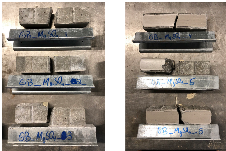
Figura 4.32 – Provetes submetidos ao ataque de MgSO_4 após rotura
