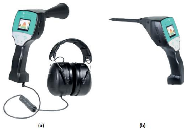
Figura 2.11 – Detetor de fugas ultrassónico LD 500 com: (a) trompete acústico e fones; (b) tubo de foco [21]
