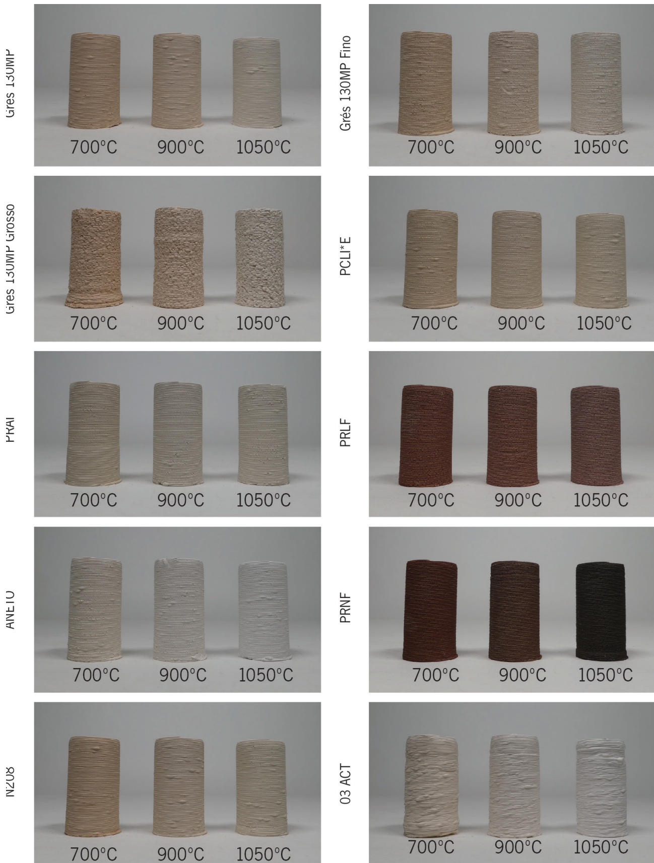
FIG. 3.18. Composição das diferentes temperaturas por pasta.
