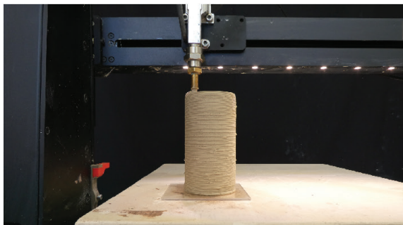
FIG. 3.7. Ilustração com provetes de cada pasta na fase da FA.
