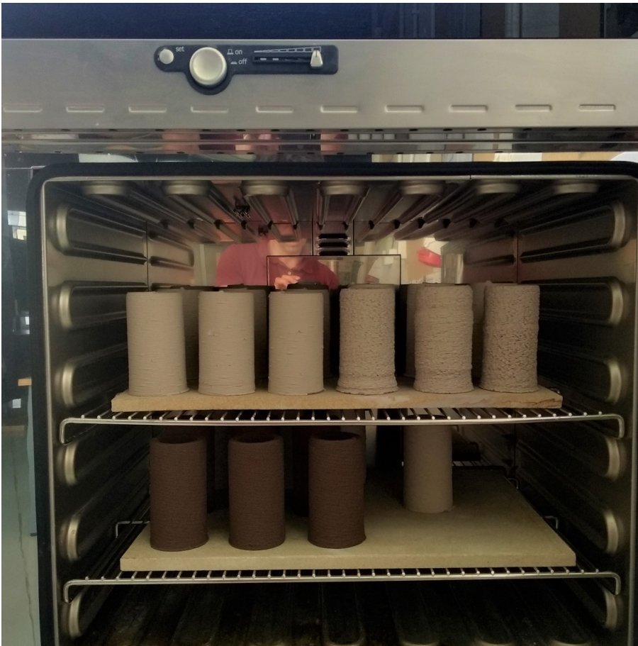
FIG. 3.10. Série de provetes na estufa a 110°C.
