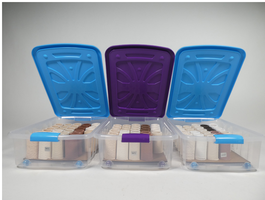
FIG. 3.11. Caixas de condicionamento dos provetes até os ensaios mecânicos.
