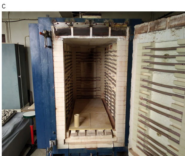
FIG. 2.20. Imagens captadas na visita à Fundação Castro Alves. (a) argila; (b) extrusora; (c) forno elétrico; (d) cabine de vidragem;
