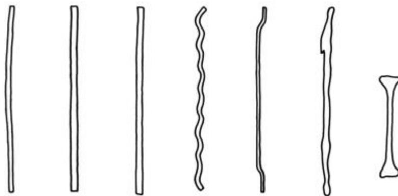
Figura 2.3: Diversos tipos de fibras de aço, secções longitudinais (Gonzalez, 2007).
