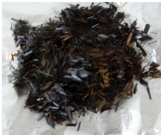
Figura 2.6: Fibras curtas de carbono (Laboratório de Nanotecnologia da Fibrenamics).
