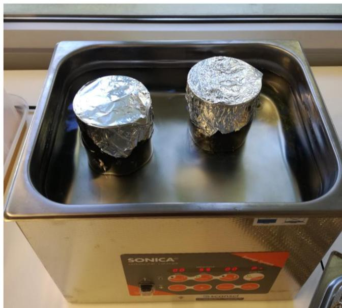
Figura 4.4: Equipamento de ultrassons com duas soluções.
