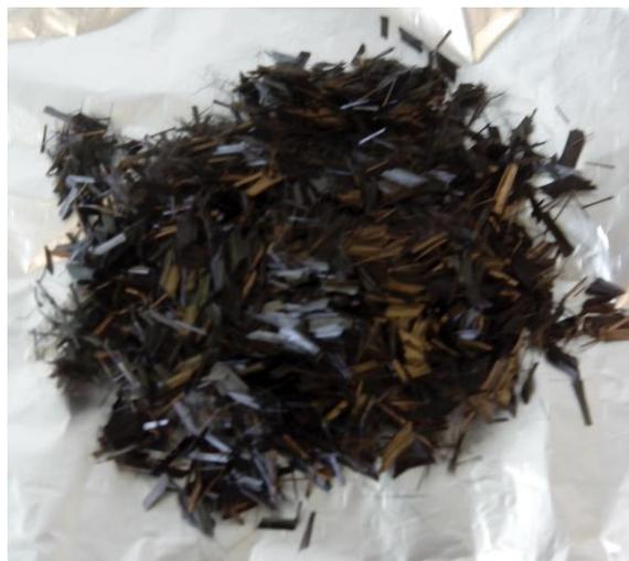
Figura 3.1: Fibras curtas de carbono utilizadas no trabalho laboratorial.
