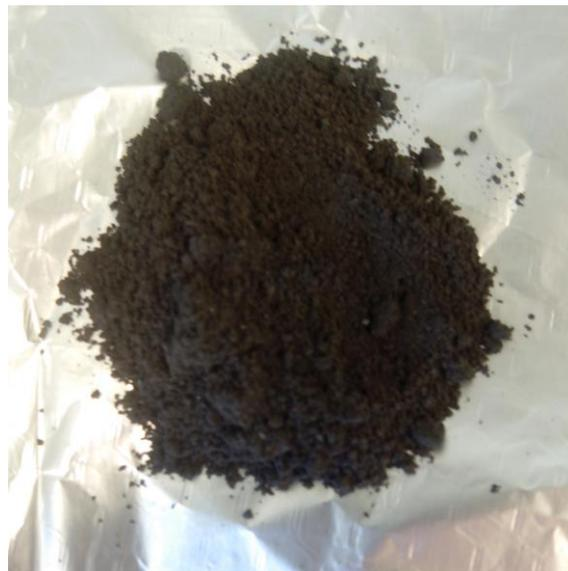
Figura 3.2: Nanofibras de carbono utilizados no trabalho laboratorial (Laboratório de Nanomateriais da Fibrenamics).
