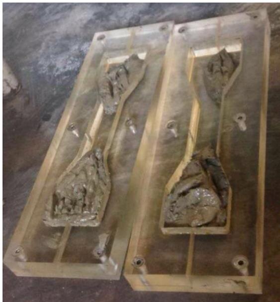
Figura 4.7: Colocação da argamassa nos moldes.
