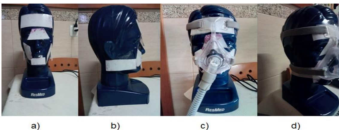
Figura 15. Distribuição dos sensores no manequim para utilização da máscara facial: a) Demonstração da colocação dos sensores nas regiões frontal, nasal (rhinion), bochechas e mentoniana (sulco mentoniano); b) Demonstração da colocação do sensor na região mandibular; c) Demonstração da colocação da máscara facial e arneses entre os sensores e o manequim; d) Demonstração da colocação dos arneses sob os sensores dispostos na região mandibular e frontal.
