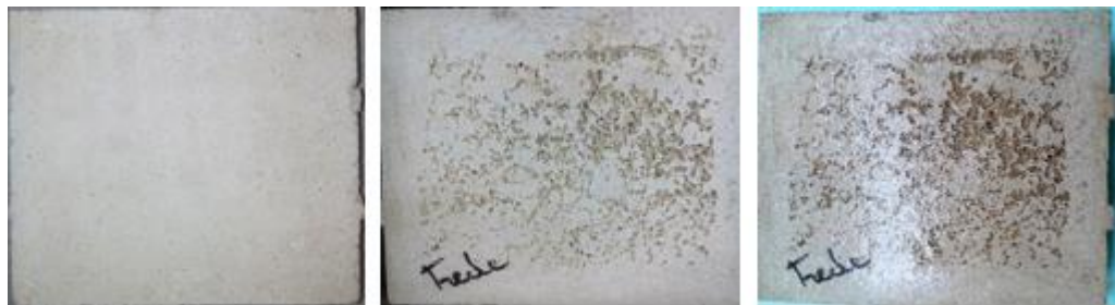
Figura 70 – Bloco para o ensaio de erosão – Composição: Rede de polipropileno
