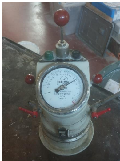
Figura 27 – Equipamento para obter o volume de vazios das argamassas no estado fresco
