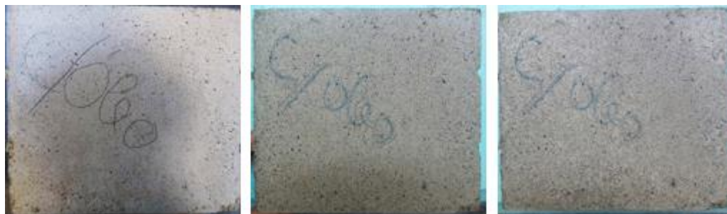
Figura 67 – Bloco para o ensaio de erosão – Composição: com óleo
