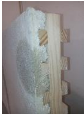
Figura 77 – Fim do ensaio de Karsten na composição sisal + cânhamo entre o ripado
