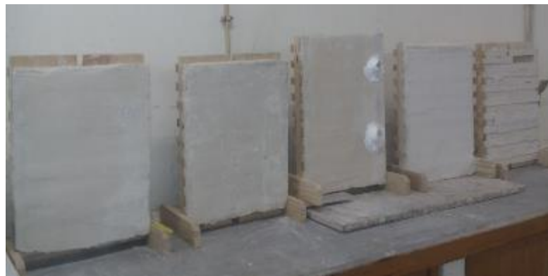
Figura 40 – Paineis para simulação de uma parede de tabique
