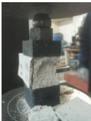
Figura 32 – Ensaio de compressão, pela prensa Lloyd com o dispositivo de compressão
