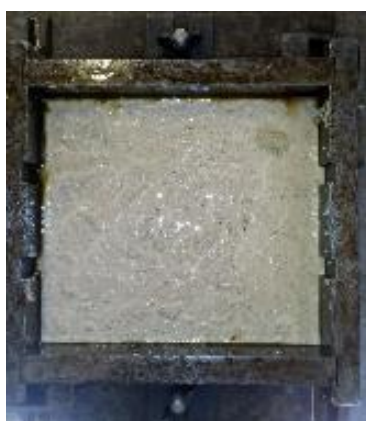
Figura 30 – Moldes dos blocos para o ensaio de erosão (20x20x2 cm)
