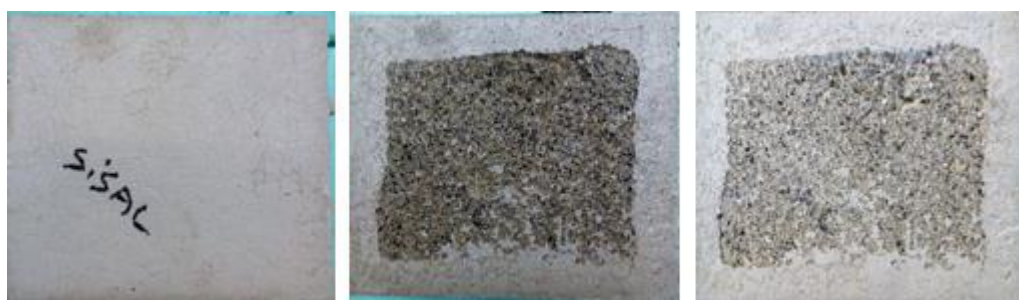
Figura 68 – Bloco para o ensaio de erosão – Composição: com sisal
