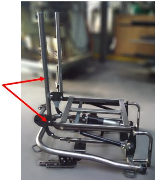
Figura 82 - Montagem do sistema superior de regulação do assento e a estrutura fixa do encosto
