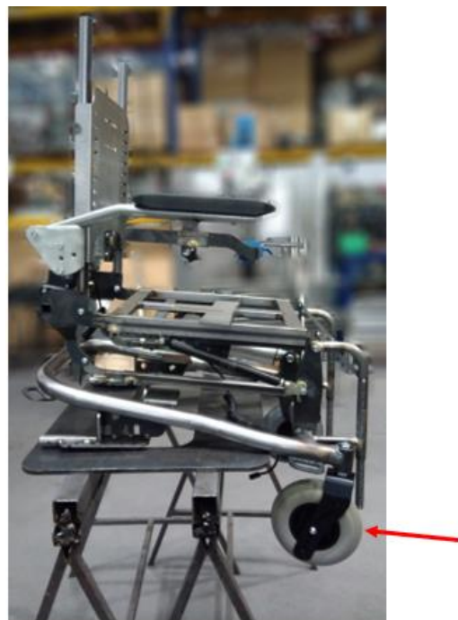
Figura 86 – Montagem das rodas dianteiras.
