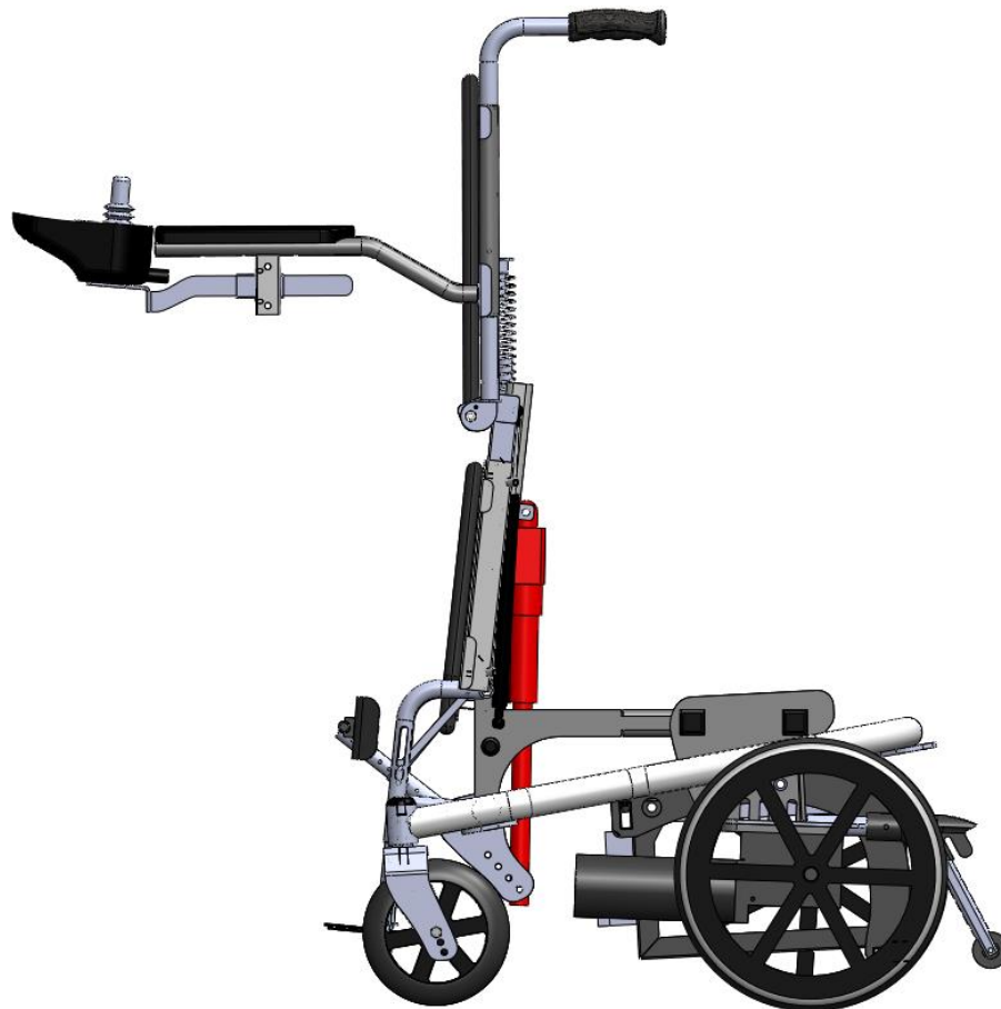
Figura 45 – Posição do motor, com a cadeira completamente verticalizada
