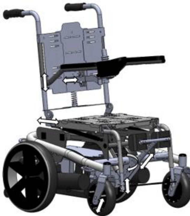
Figura 37 – Cadeira de verticalização com os ajustes definidos pelas setas [1]
