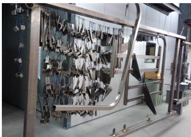
Figura 74 – Peças penduradas, prontas a iniciar o processo de pintura
