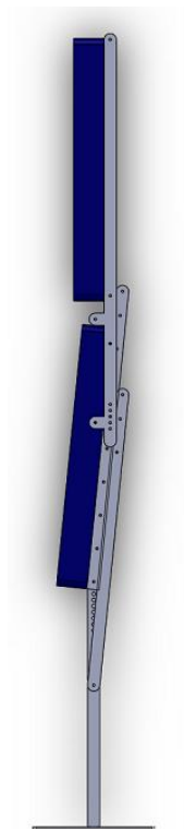
Figura 51 – Representação da interferência dos pontos de articulação com a almofada do assento
