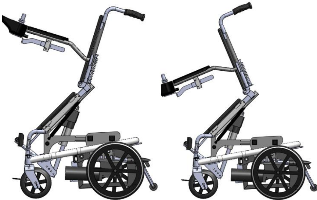
Figura 43 – Oscilação do assento para trás (esquerda) e para a frente (direita) com o assento fixo
