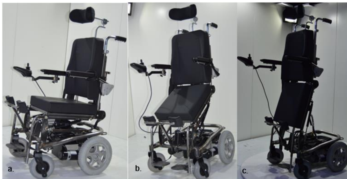
Figura 90 – Protótipo físico da cadeira de verticalização elétrica, com o assento na posição inicial (a.), com o assento a 30° (b) e com o assento a 60° (c.)
