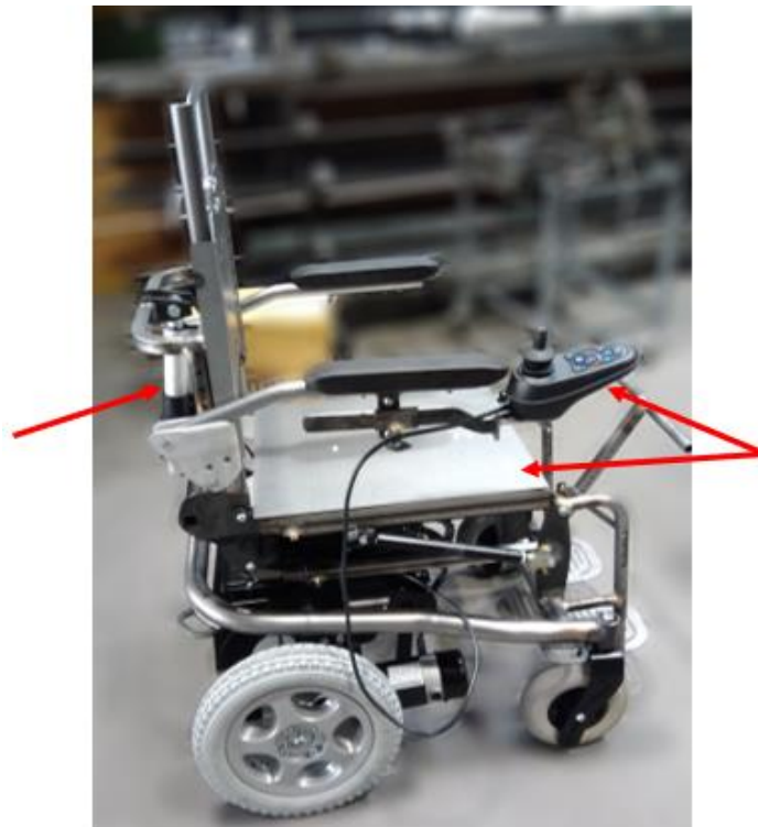
Figura 88 – Montagem do atuador linear do encosto, chapas do assento e joystick
