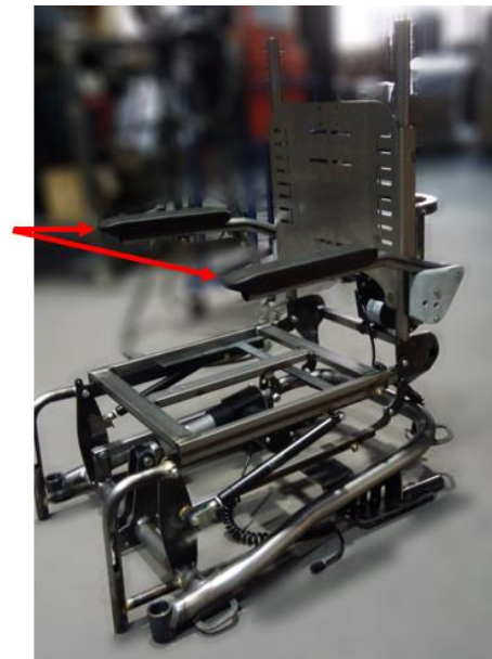
Figura 84 – Montagem dos apoios de braços
