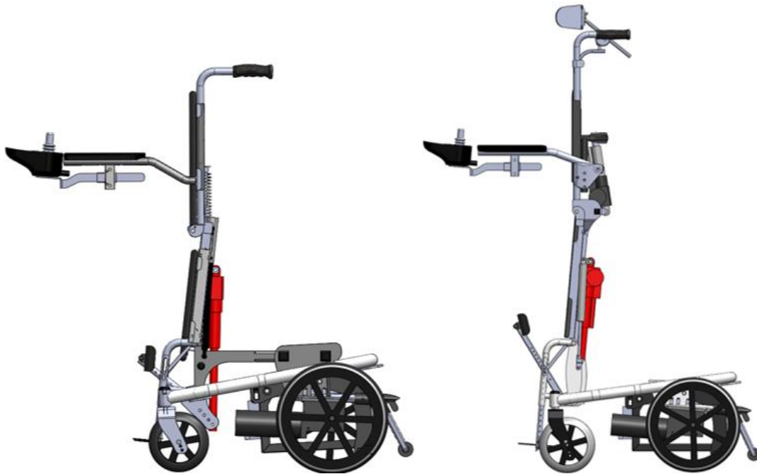
Figura 59 – Posicionamento do motor no protótipo anterior [1] e no atual, na posição final
