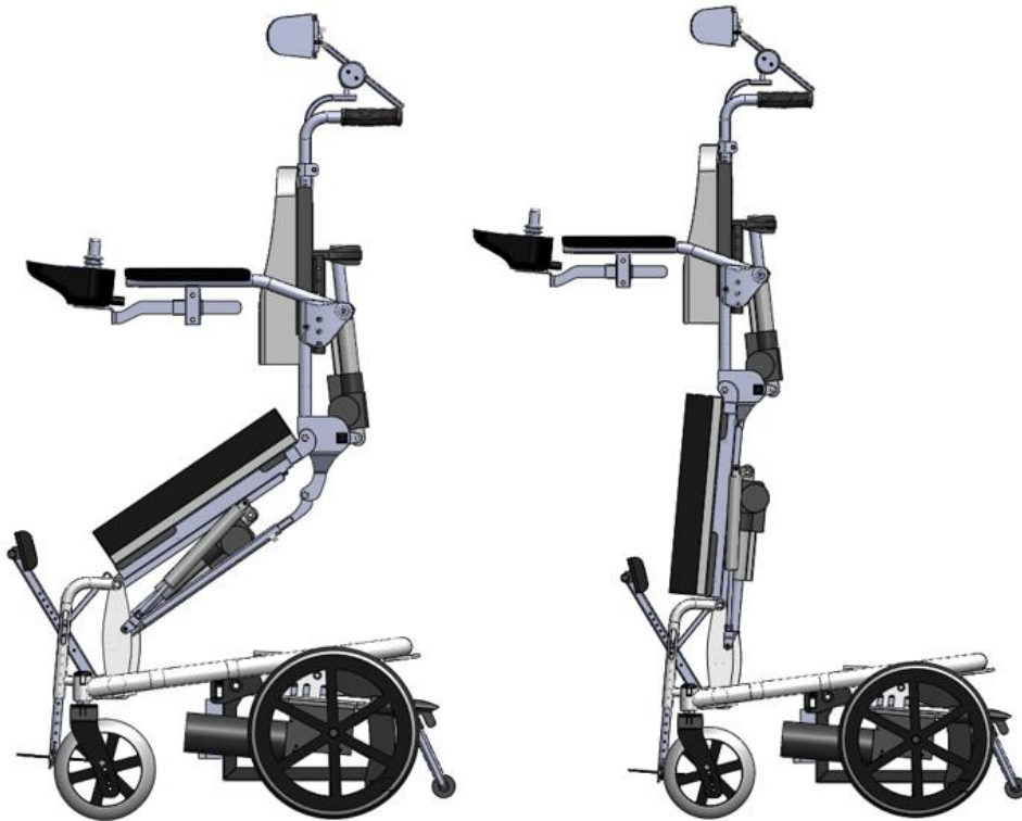
Figura 54 – Demonstração da cadeira de verticalização em duas posições, sempre com o encosto vertical
