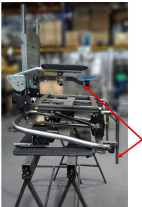
Figura 85 – Montagem da chapa para fixar o Joystick e o tubo interior do patim.
