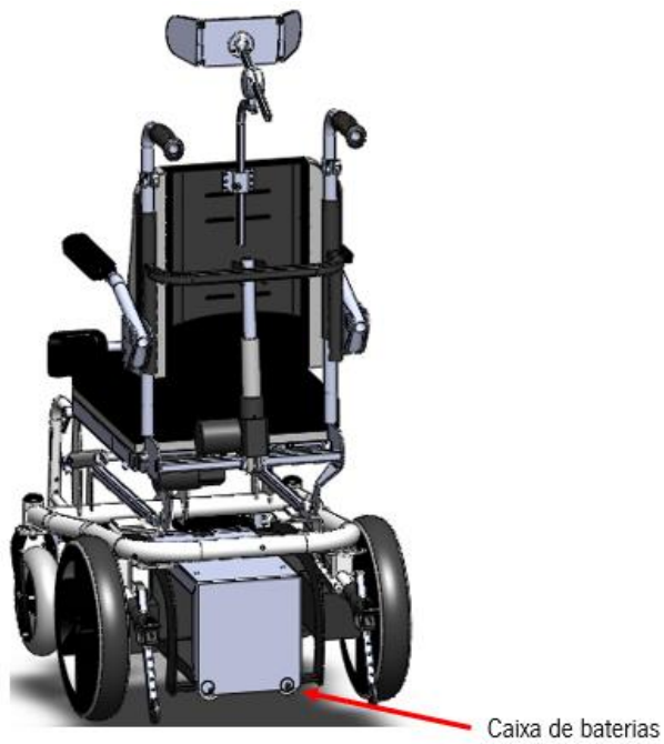
Figura 69 – Localização da caixa de baterias
